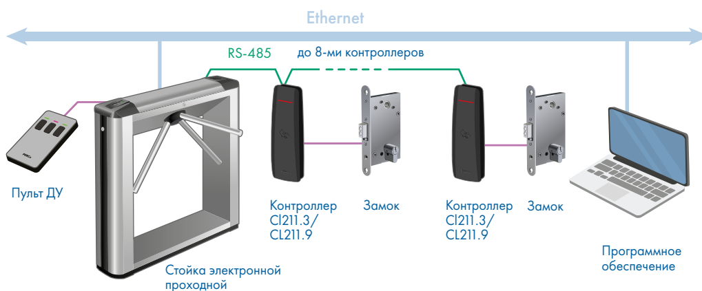
Структурная схема подключения электронной проходной
