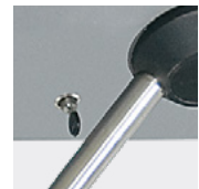
Механическая разблокировка ключом
