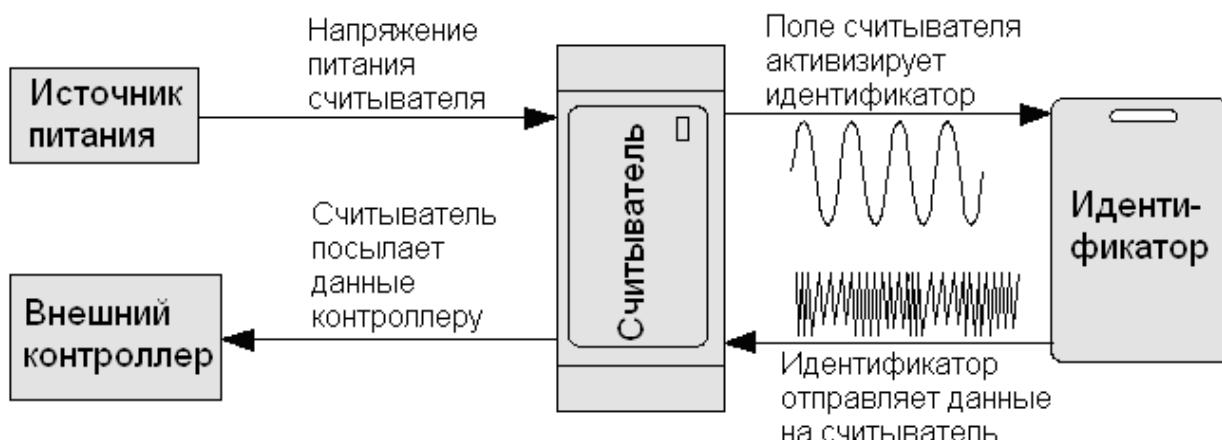
Рисунок 11. Функциональная схема, поясняющая работу считывателя
