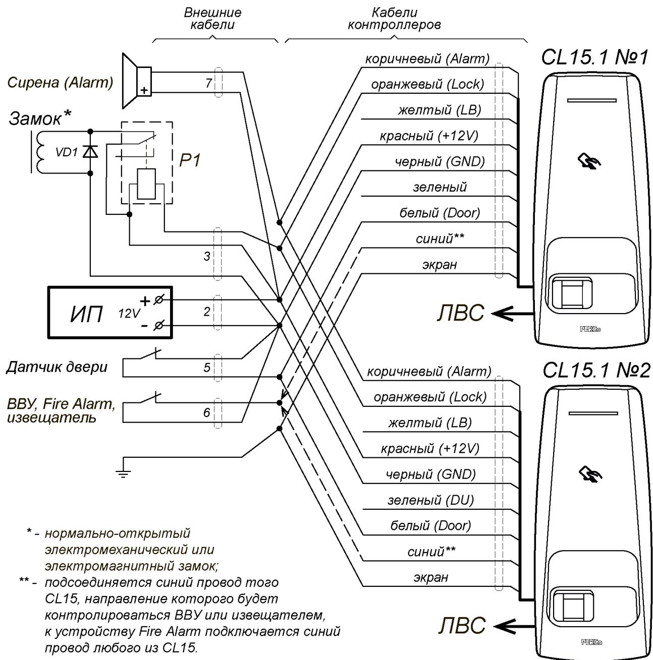
Рисунок 6. Схема параллельного подключения двух контроллеров для управления двусторонней дверью, оборудованной нормально открытым электромеханическим или электромагнитным замком<sup>1</sup>
