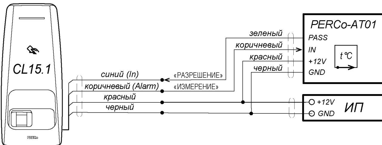
Рисунок 14. Схема подключения к контроллеру PERCo-CL15.1 пирометра PERCo-AT01
