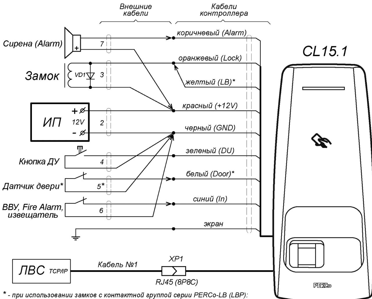
**Рисунок 3. Схема подключений PERCo-CL 15.1
