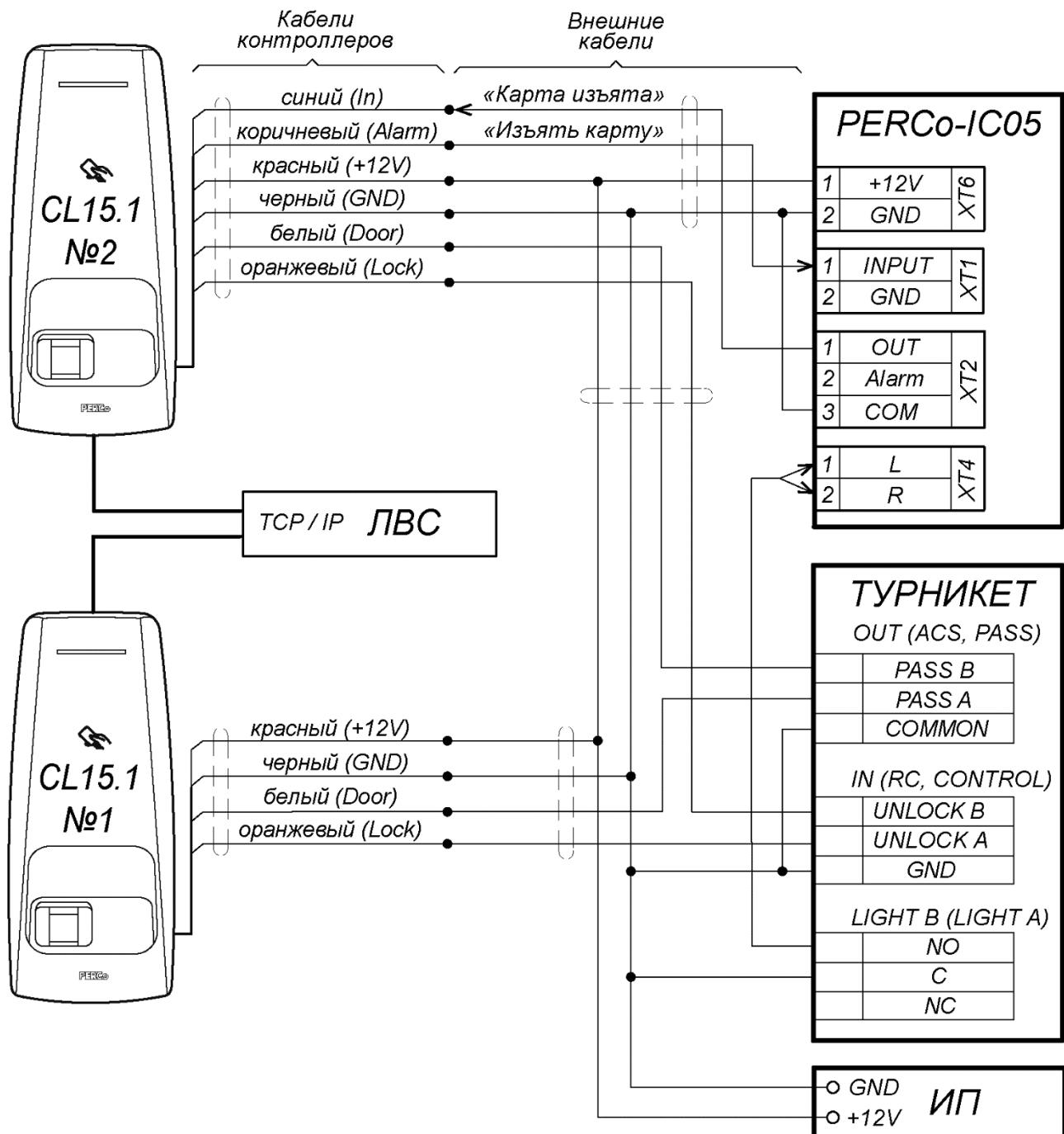
Рисунок 15. Схема подключения PERCo-CL15.1 к турникуту с картоприемником PERCo-IC05
