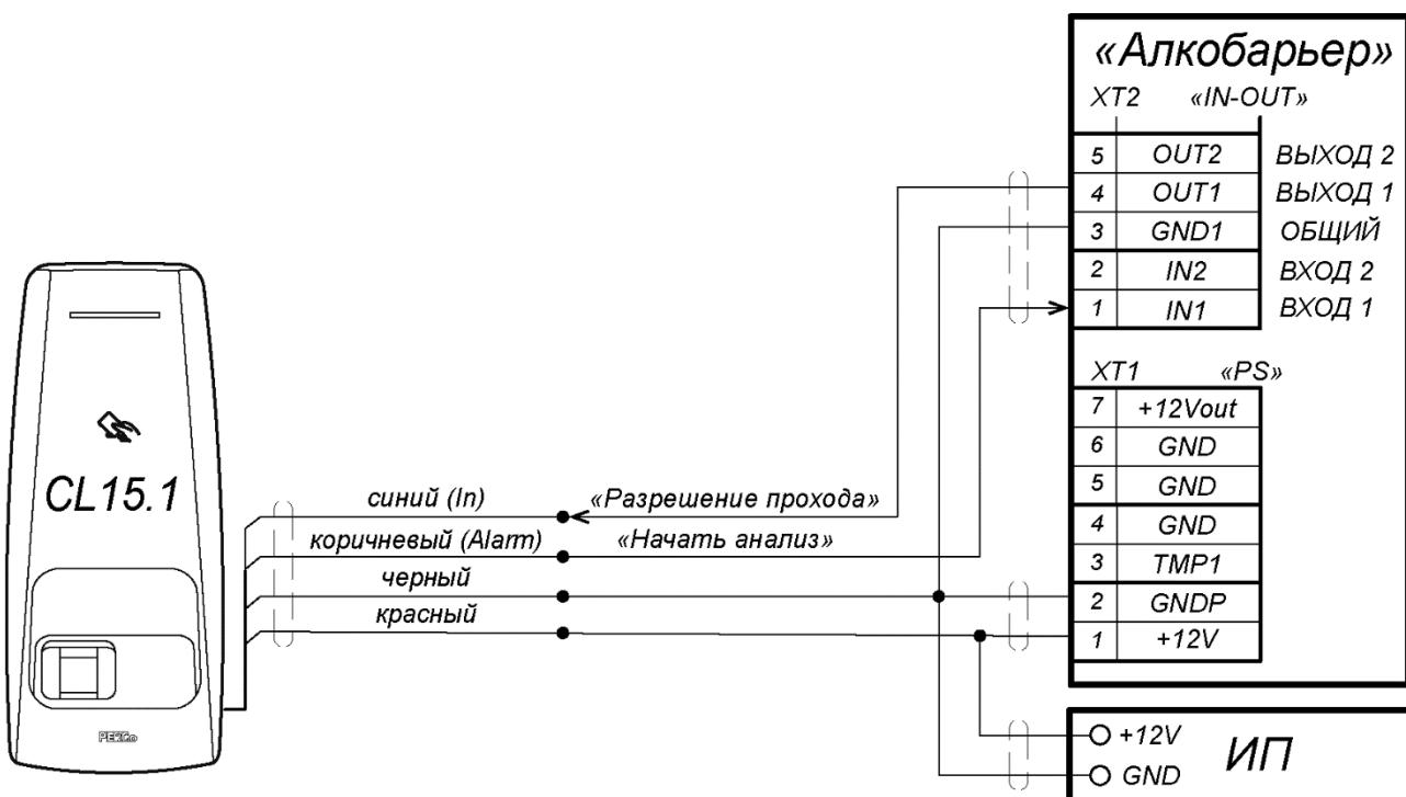
Рисунок 10. Схема подключения ВВУ на примере алкотестера
