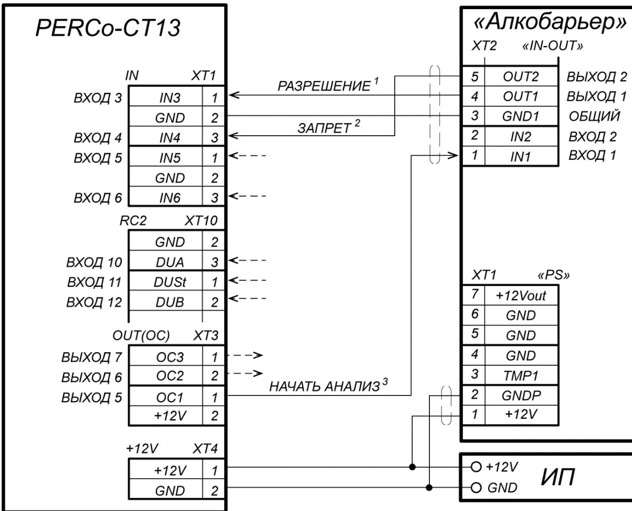
1, 2 - для подключения выходов алкотестера РАЗРЕШЕНИЕ и ЗАПРЕТ используются два разных входа контроллера из любых свободных,
