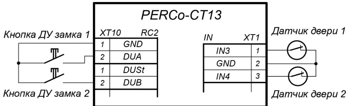
Рисунок 17. Схема подключений кнопок ДУ и датчиков двери
