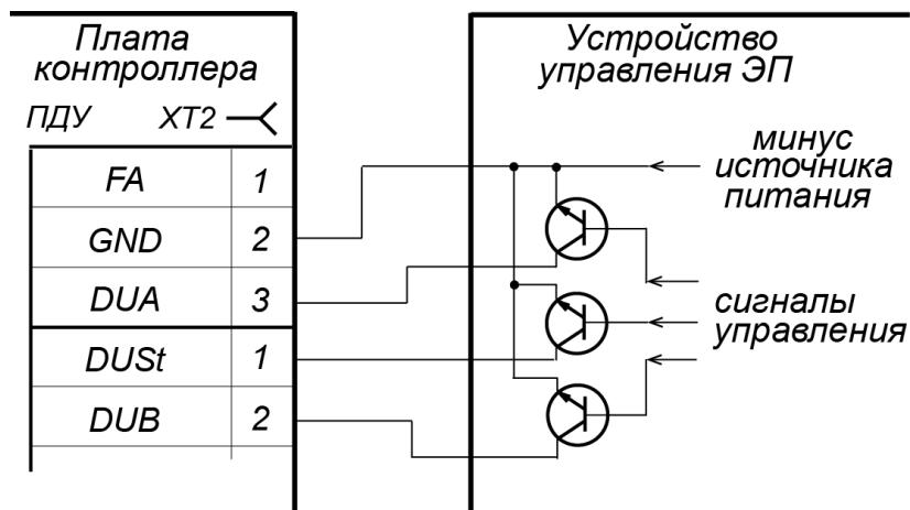
Рисунок 11. Управляющие элементы устройства управления ЭП:
