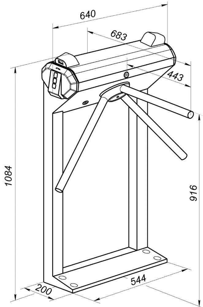
Рисунок 1. Габаритные размеры ЭП
