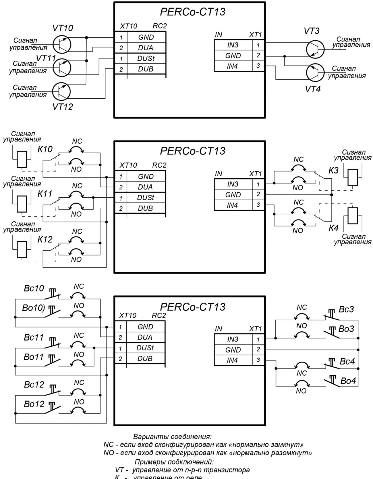
Рисунок 23. Схема подключений доп. оборудования к входам контроллера
