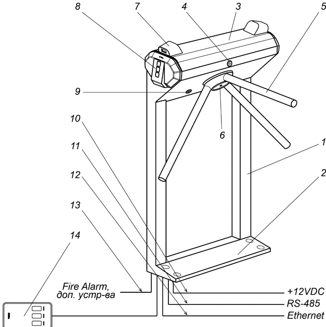
Рисунок 2. Устройство ЭП
