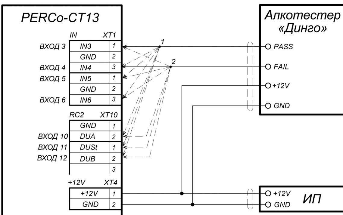
1, 2 - для подключения алкотестера используются **два разных** входа контроллера из любых свободных.
