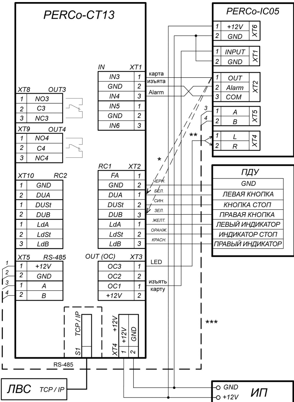
\* Если все дополнительные входы контроллера заняты, то выход картоприемника OUT (сигнал «Карта изъята») может подключаться параллельно ПДУ ко входу управления контроллера DU A или DU B в зависимости от направления прохода.
