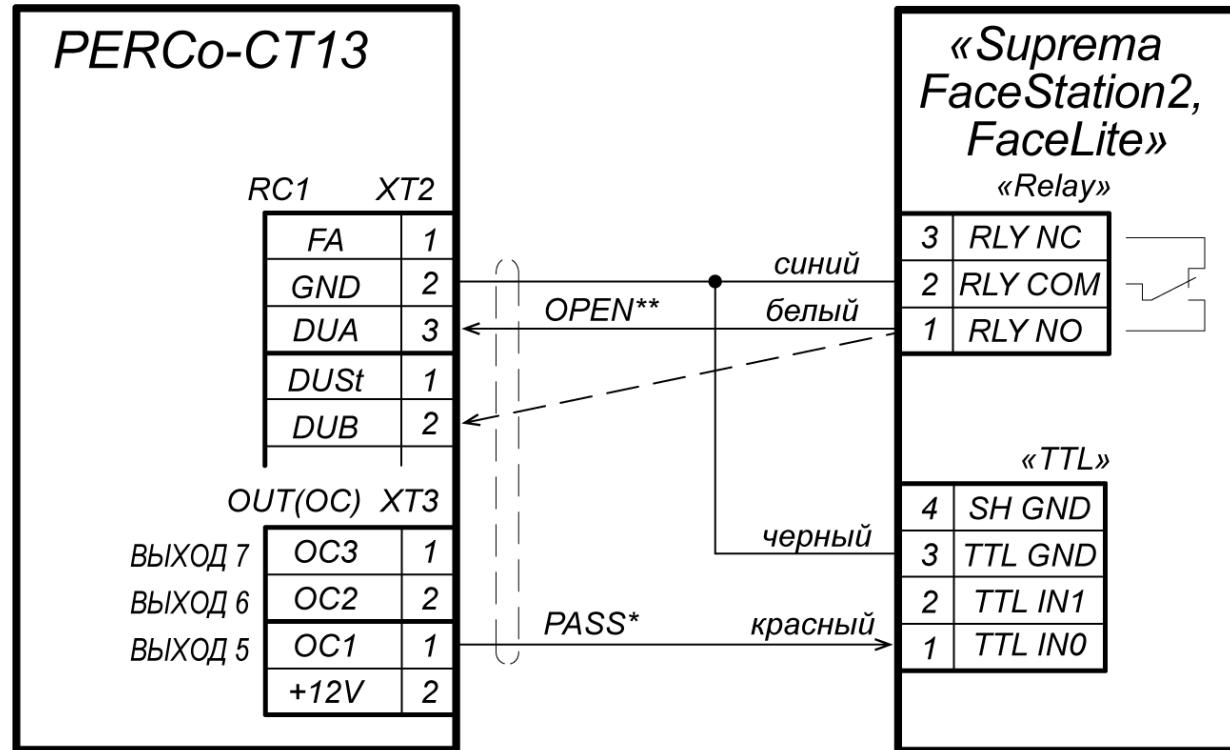
\* - для сигнала PASS может быть использован любой свободный выход контроллера ЭП (тип выхода - «Обычный»), для него в Web-интерфейсе необходимо задать внутреннюю реакцию:
