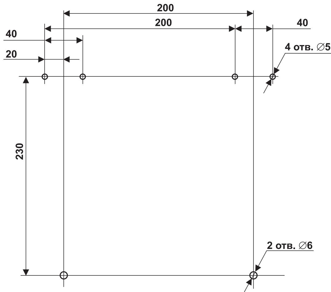
Рис. 2. Разметка крепления блока контроллеров
