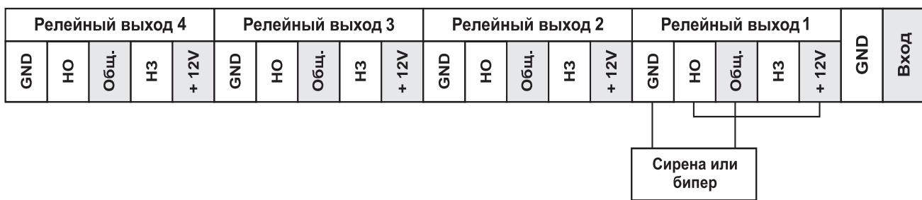
Схема 1. Подключение внешних устройств к контроллеру
