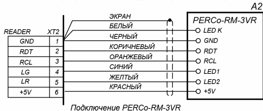
Рисунок 2. Схема подключений к контроллеру
