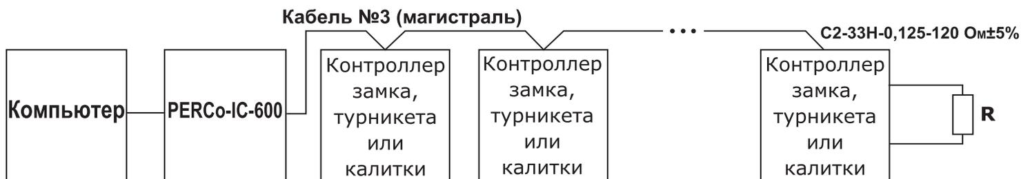
Рисунок 1 - Схема соединения контроллеров в системе
