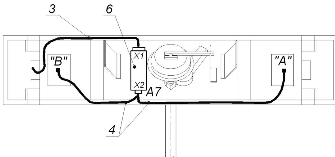
**Рисунок 12. Схема прокладки кабелей в стойке турникета:**
