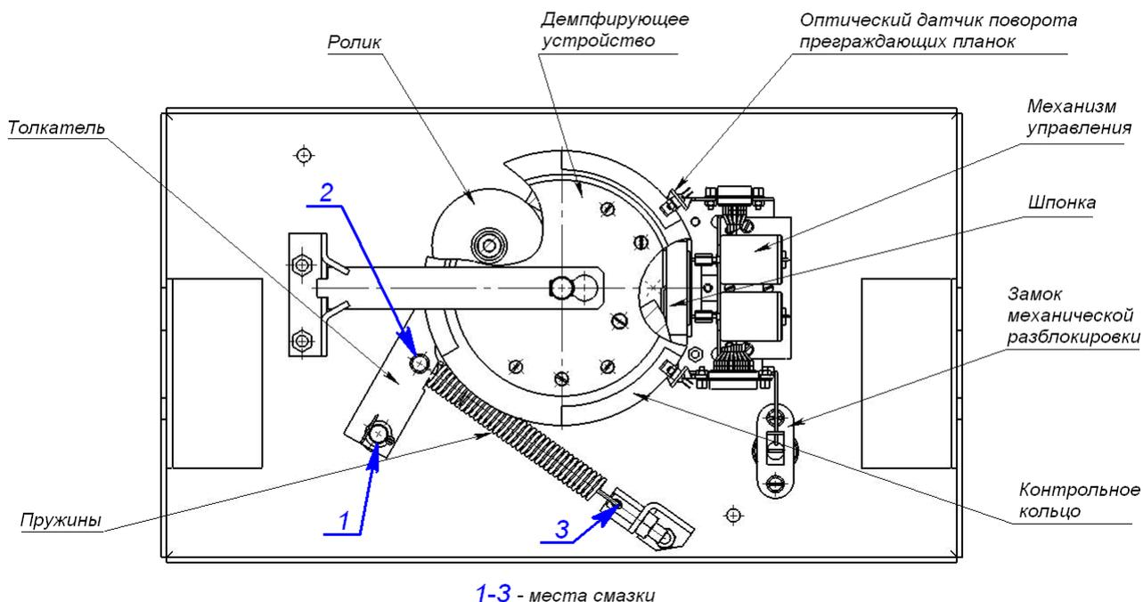
**Рисунок 15. Расположение внутренних деталей и узлов стойки турникета**
