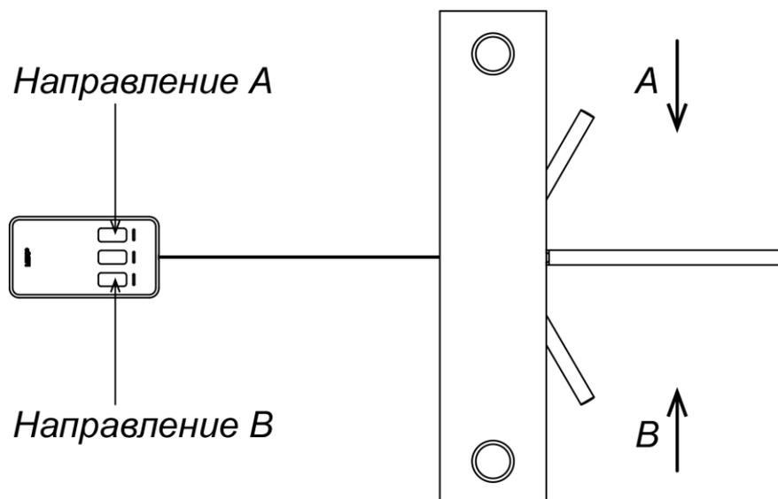
Рисунок 7. Стандартная ориентация ПДУ относительно стойки турникета
