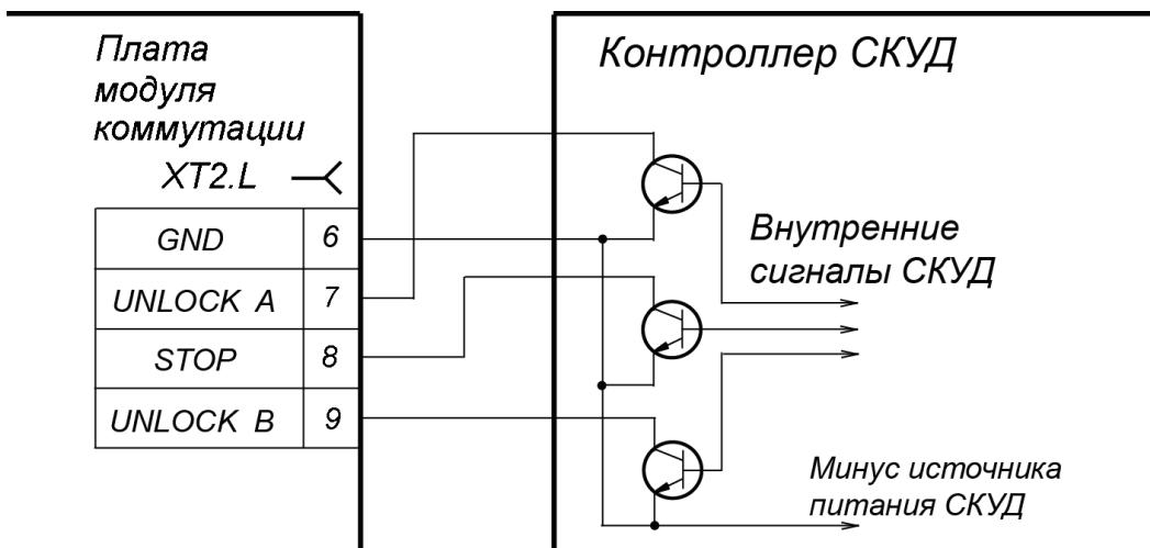
Рисунок 6. Управляющий элемент СКУД –
