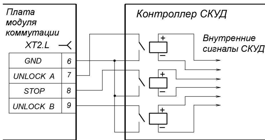
Рисунок 5. Управляющий элемент СКУД –
