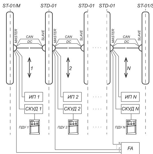
Схема соединений турнкета PERCo-ST-01 и двусторонних секций PERCo-STD-01 для организации проходной с несколькими зонами прохода
