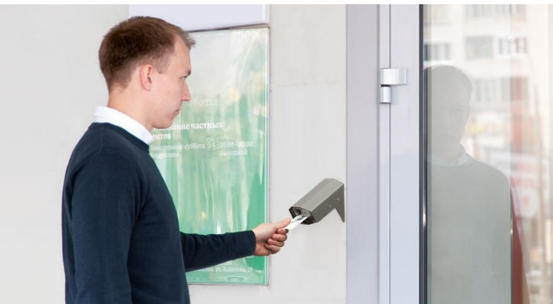
Система ограничения доступа к банкомату PERCo-S-800 предназначена для обеспечения безопасности клиентов и защиты оборудования.
