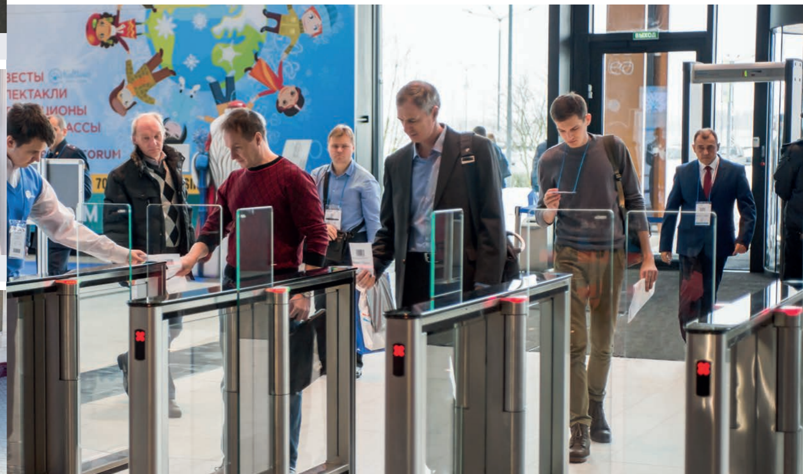
Скоростные проходы PERCo-ST01 под управлением контроллера PERCo-C01, Экспофорум, Санкт-Петербург
