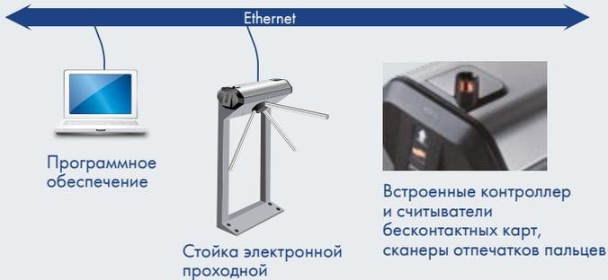
Электронные проходные имеют возможность прямого подключения к компьютерной сети предприятия. К электронной проходной можно подключить до 8 контроллеров со встроенным считывателем, управляющих замками.
