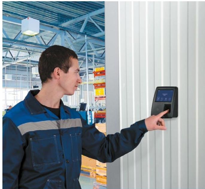
Терминал учета рабочего времени — это контроллер со встроенными считывателями для регистрации прихода/ухода и информационным табло.
