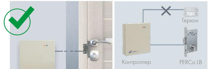
Сигнал о положении двери (открыто, закрыто) подается через контакты в засове замка, дополнительная установка геркона при работе с контроллерами PERCo не требуется.
