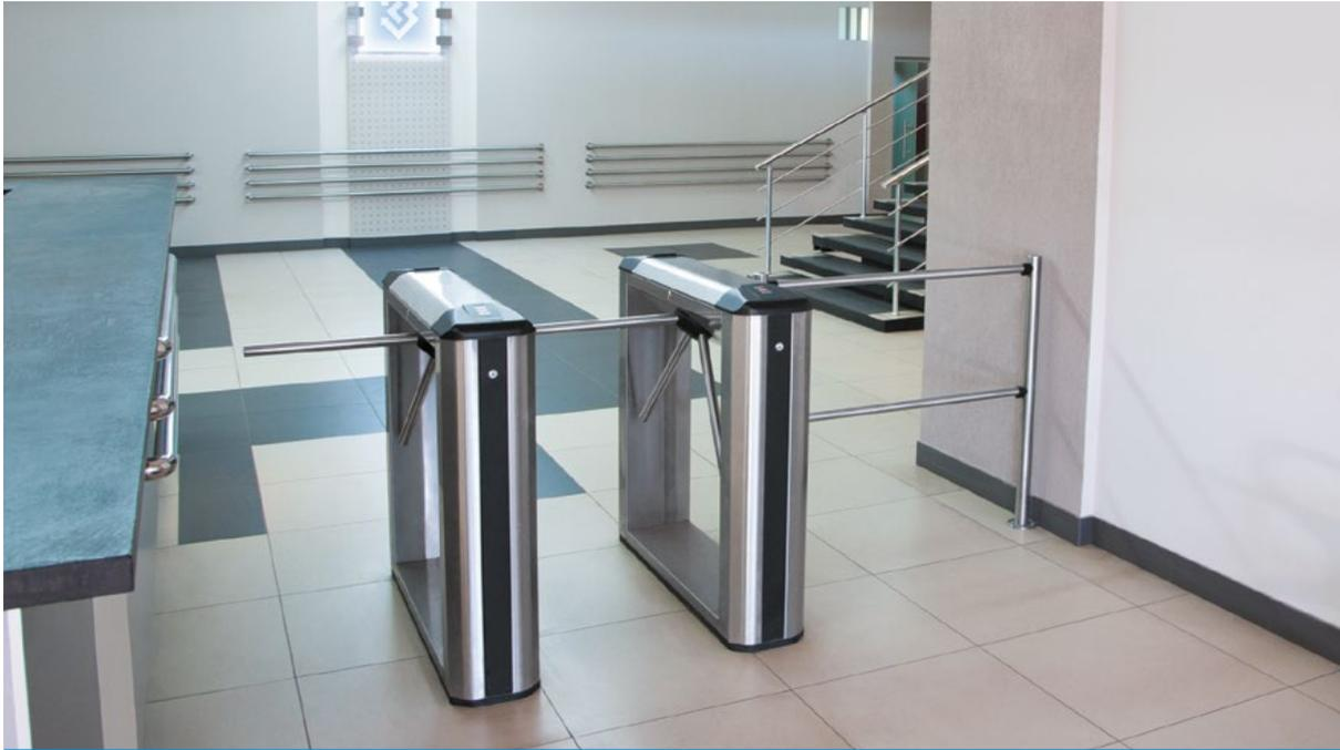
За счет того, что контроллеры, считыватели и картоприемники встроены внутрь корпусов турникетов, монтаж электронных проходных требует минимальных трудозатрат и не вносит лишних элементов в дизайн проходной.
