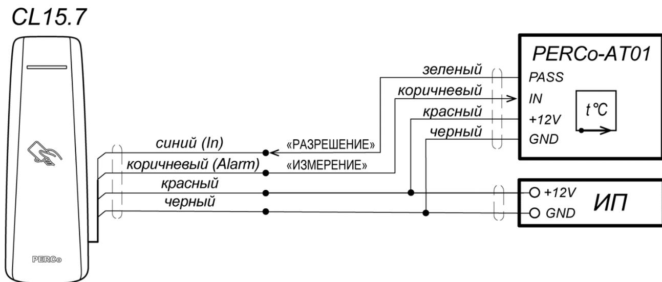
Рисунок 12. Схема подключения пирометра *PERCo-AT01* к контроллеру *CL15.7*
