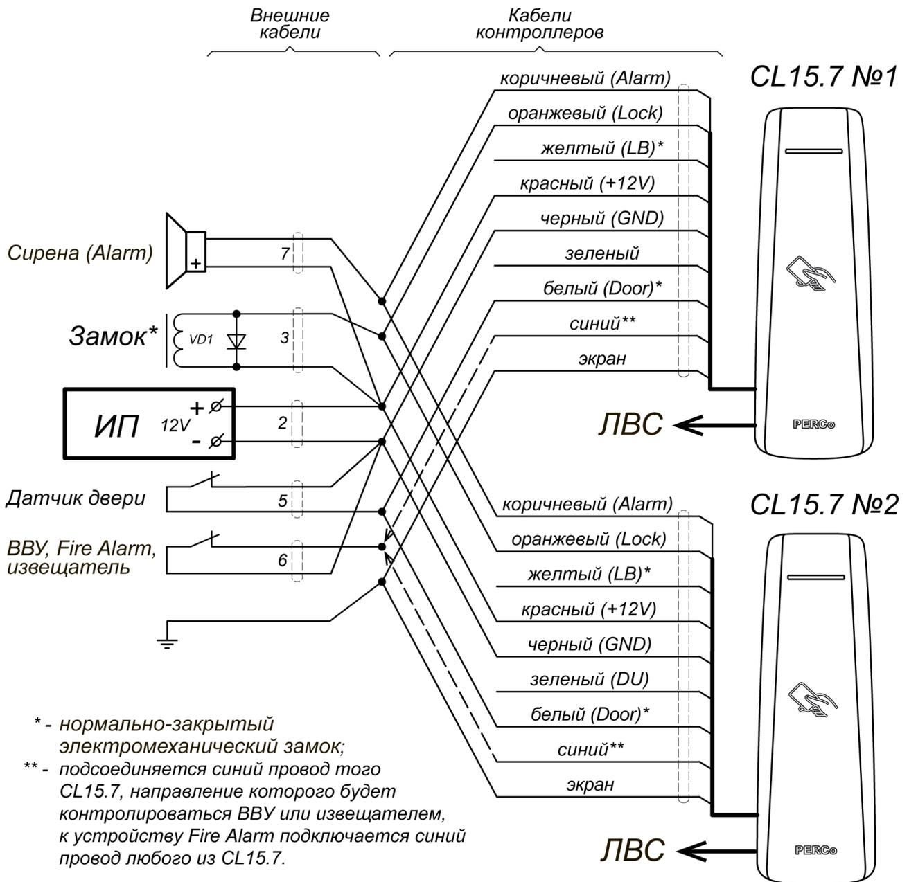
**Рисунок 5. Схема параллельного подключения двух контроллеров для управления двусторонней дверью, оборудованной нормально закрытым электромеханическим замком**
