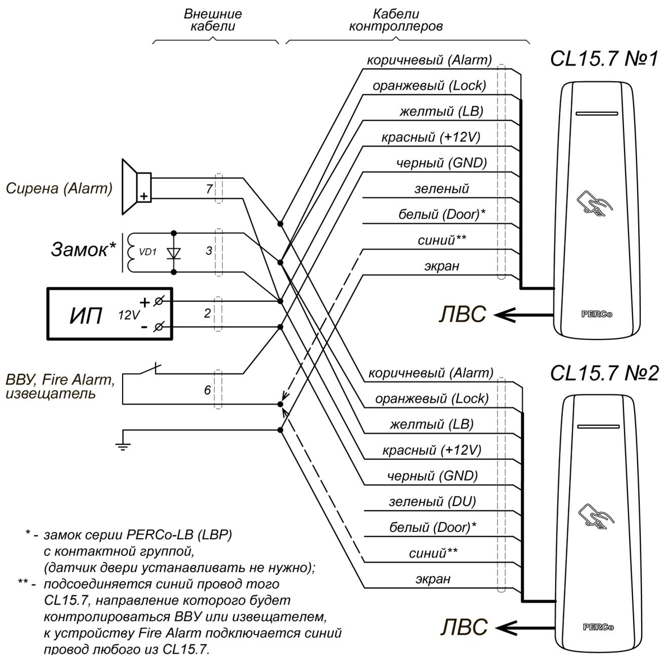
**Рисунок 4. Схема параллельного подключения двух контроллеров для управления двусторонней дверью, оборудованной замком с контактной группой типа PERCo-LB (LBP) <sup>1</sup>**
