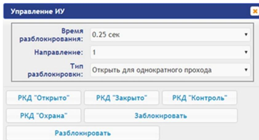
3. С помощью кнопок в нижней части окна подайте нужную команду. Окно управления будет закрыто, команда будет передана в контроллер. Также закрыть окно без подачи команды можно при помощи кнопки **Close**
