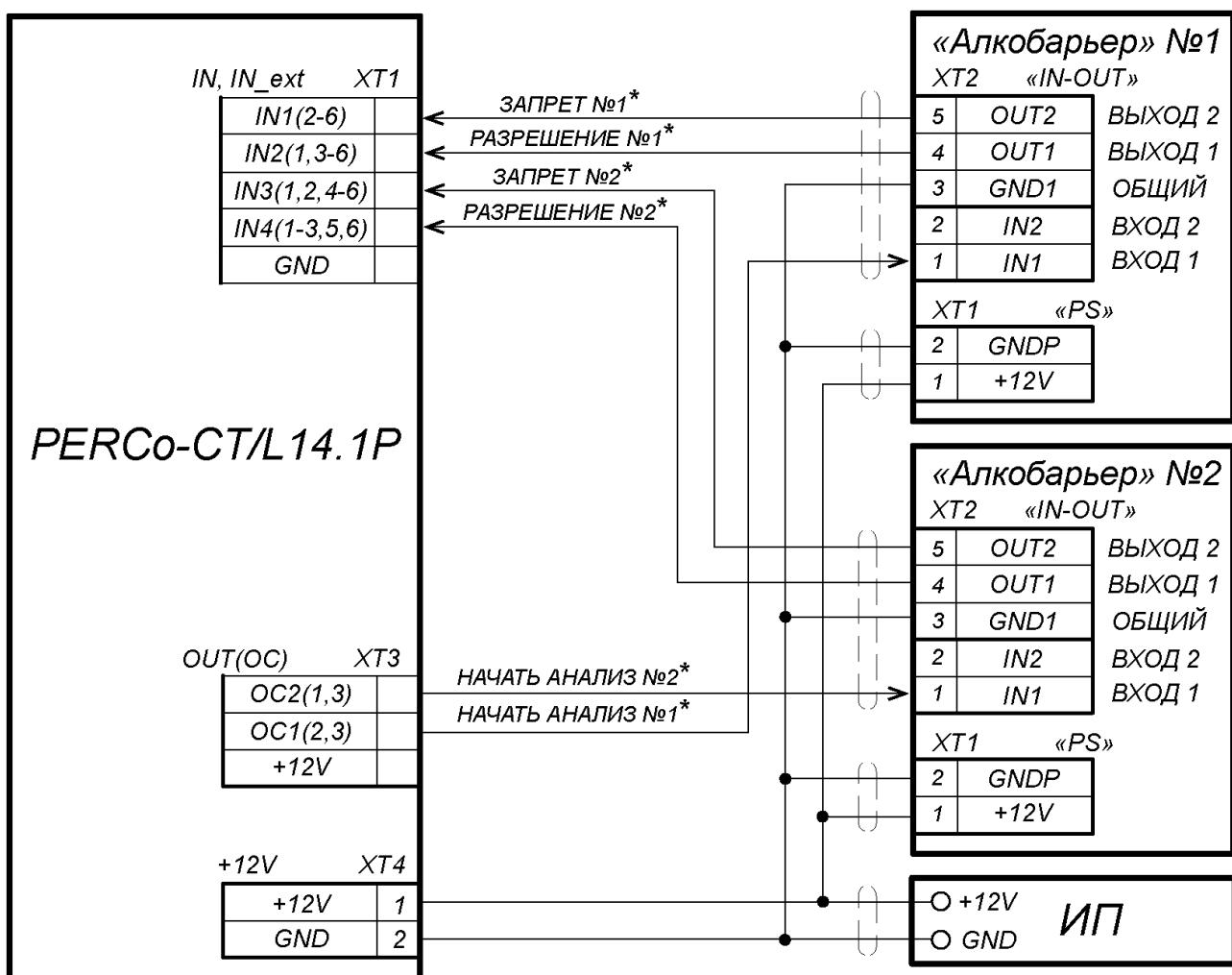
\* - для подключения выходов алкотестеров РАЗРЕШЕНИЕ и ЗАПРЕТ используются 4 разных входа контроллера из любых свободных, для сигнала НАЧАТЬ АНАЛИЗ используется любой свободный выход контроллера.
