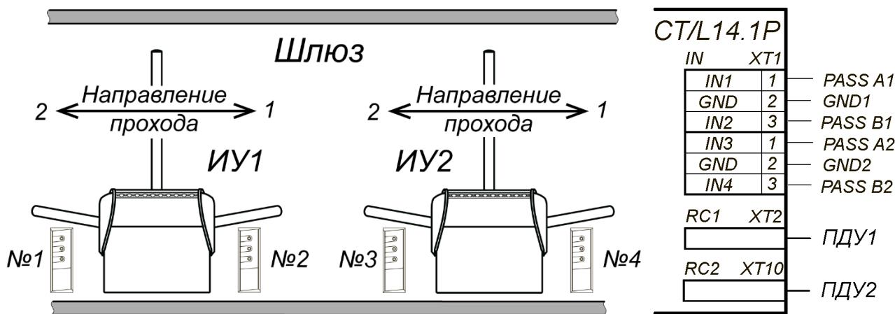
Рисунок 24. Схема шлюза из двух турникетов
