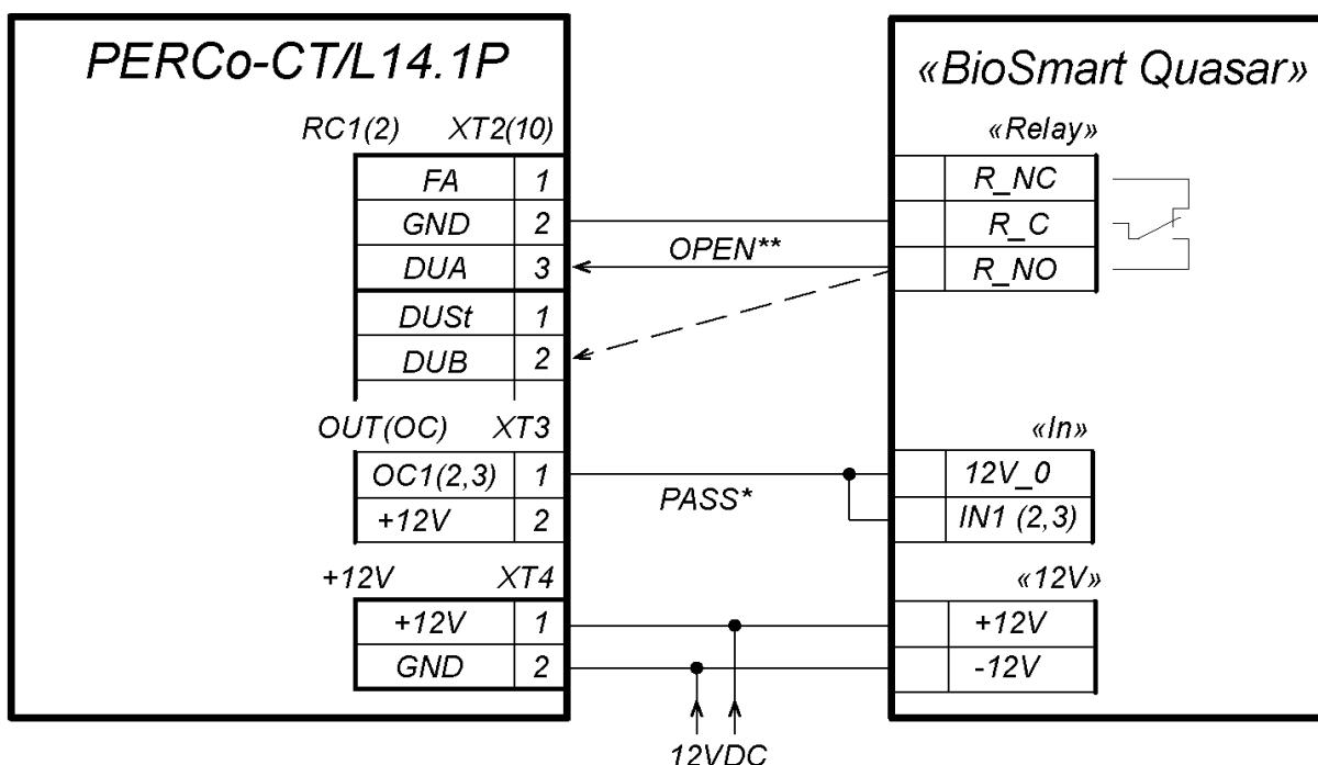
\* - Для сигнала PASS используется любой свободный выход типа «открытый коллектор» CT/L14.1P, тип выхода - «Обычный - Нормально запитан»
