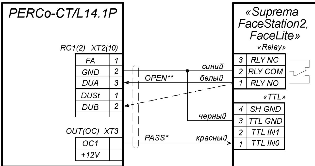
\* - для сигнала PASS может быть использован любой свободный выход контроллера CT/L14.1P (тип выхода - «Обычный»), для него в Web-интерфейсе необходимо задать внутреннюю реакцию: «Закрывание ИУ направления 1(2) ИУ1(2) - активизировать выход на абсолютное время 1 сек» .
