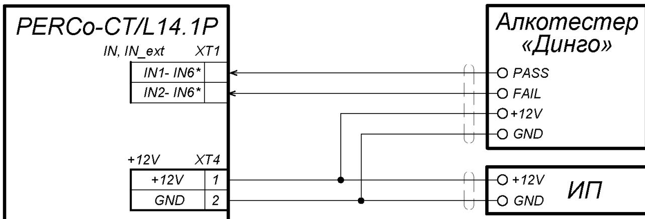
\*- для подключения алкотестера используются **два разных** входа контроллера из любых свободных.
