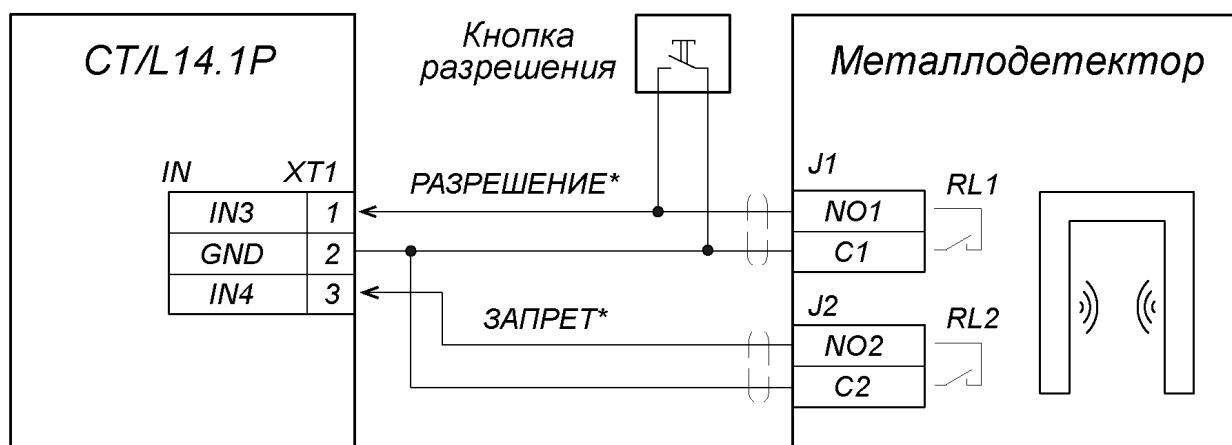
\* - для подключения выходов металлодетектора РАЗРЕШЕНИЕ и ЗАПРЕТ используются два разных входа контроллера из любых свободных.
