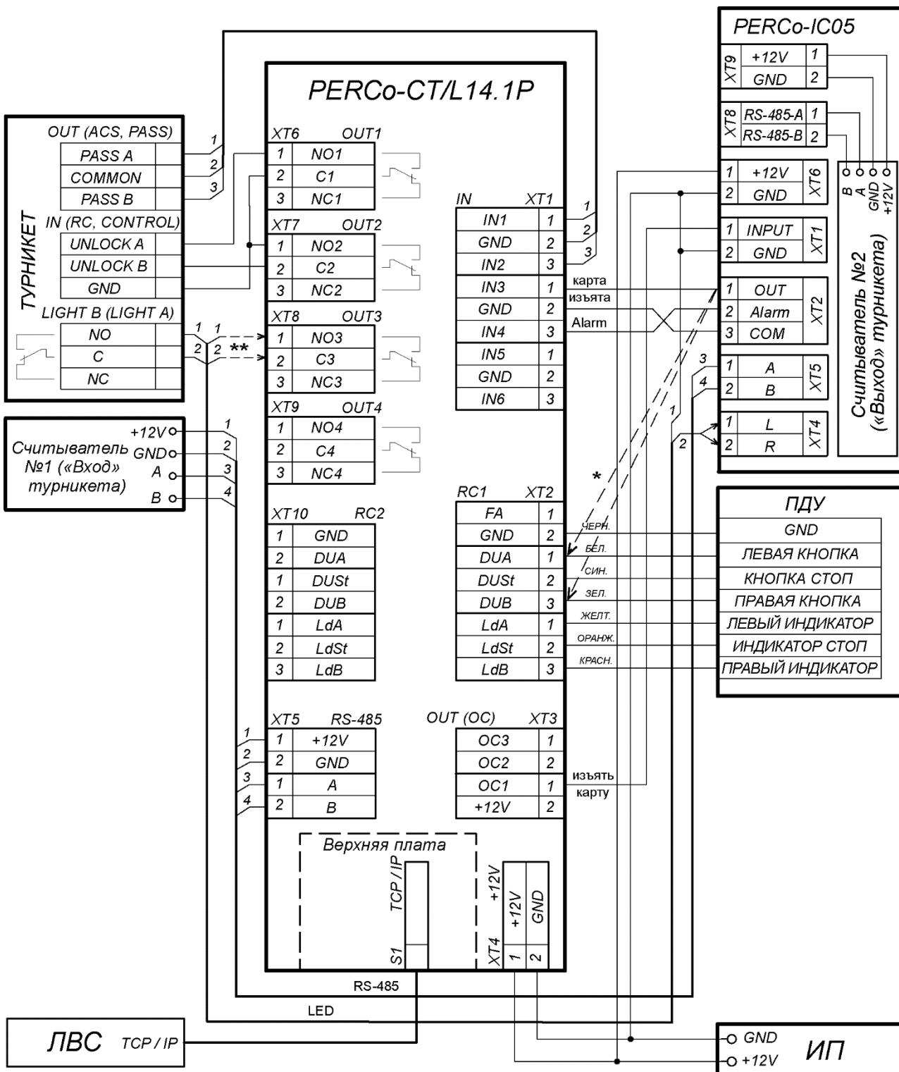
\* Если все дополнительные входы контроллера заняты, то выход картоприемника OUT (сигнал «Карта изъята») может подключаться параллельно ПДУ ко входу управления контроллера DU A или DU B в зависимости от направления прохода.
