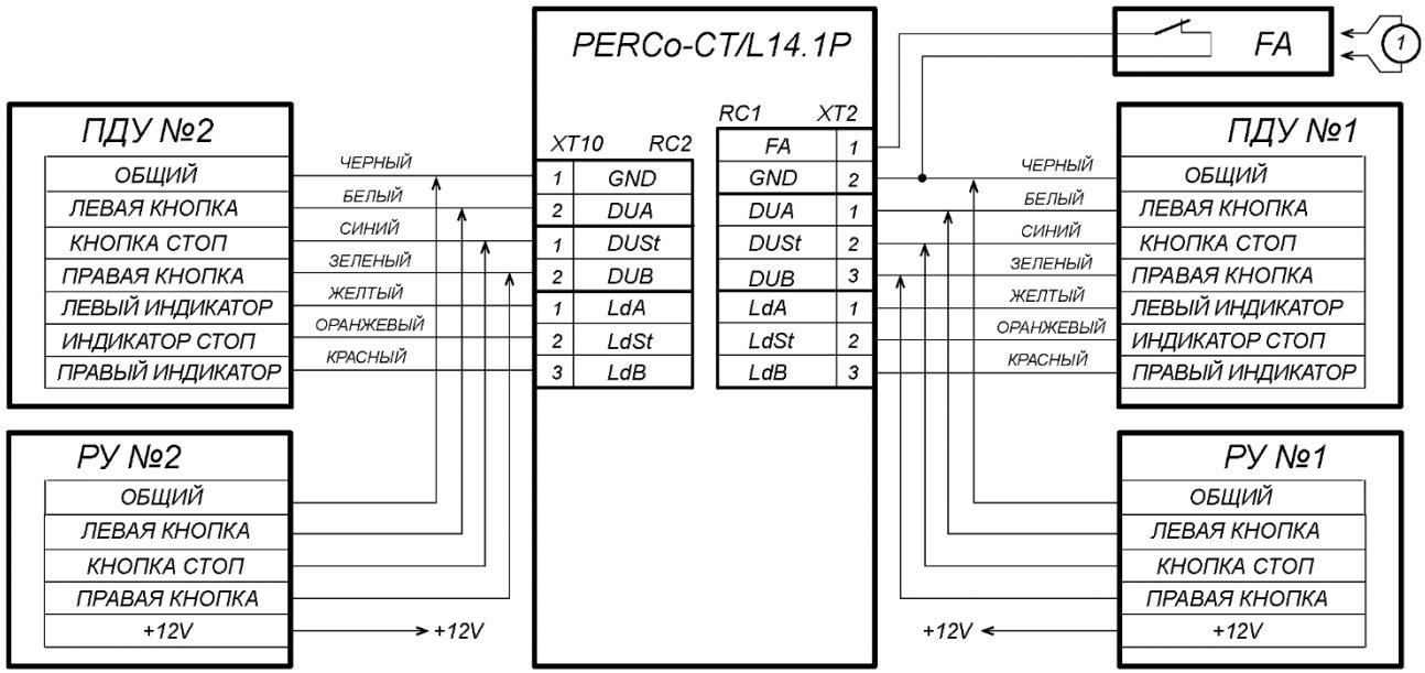
(1) – провод-перемычка, устанавливается при отсутствии устройства FA
