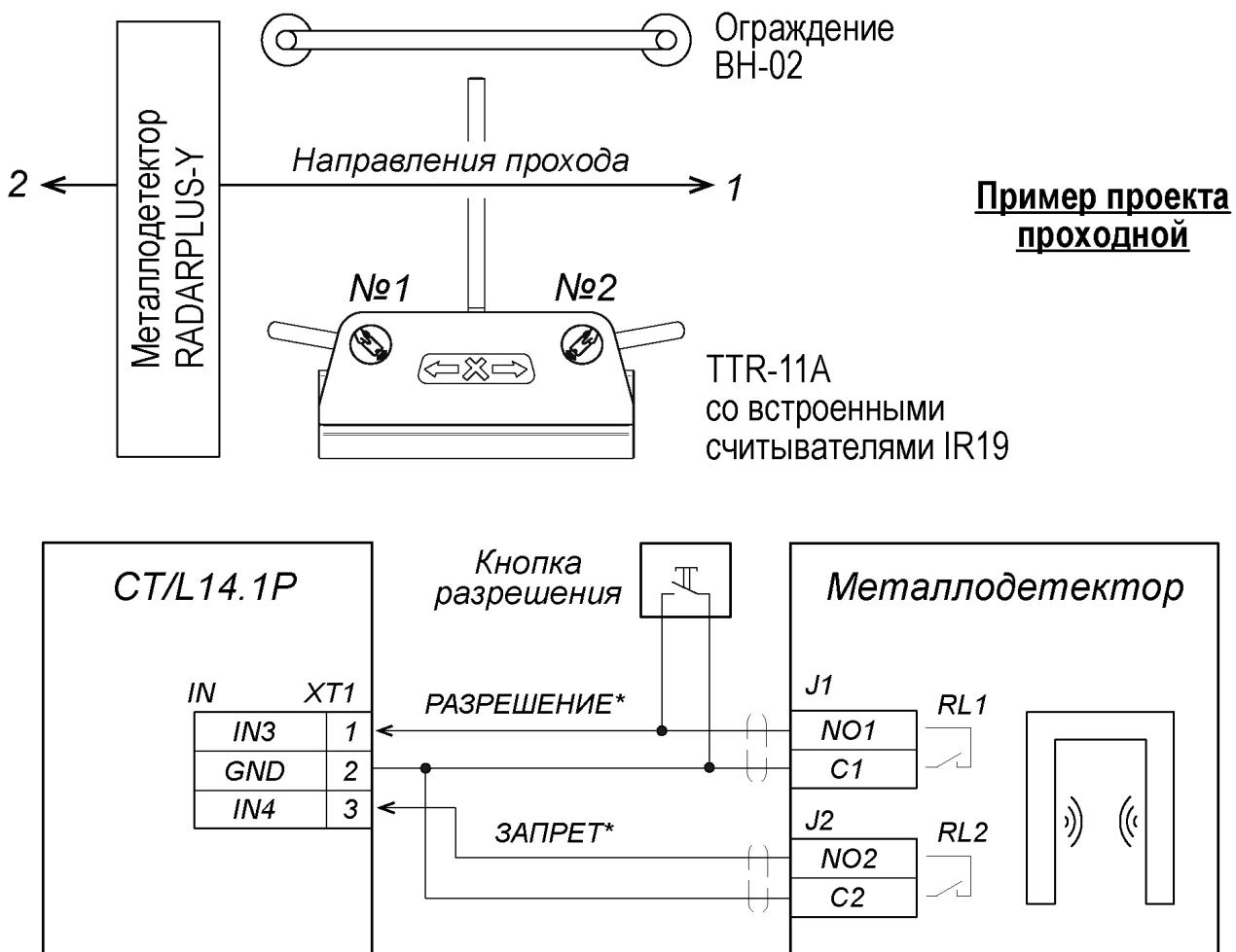
\* - для подключения выходов металлодетектора РАЗРЕШЕНИЕ и ЗАПРЕТ используются два разных входа контроллера из любых свободных.
