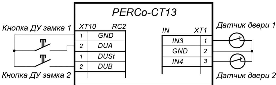
Рисунок 16. Схема подключений кнопок ДУ и датчиков двери
