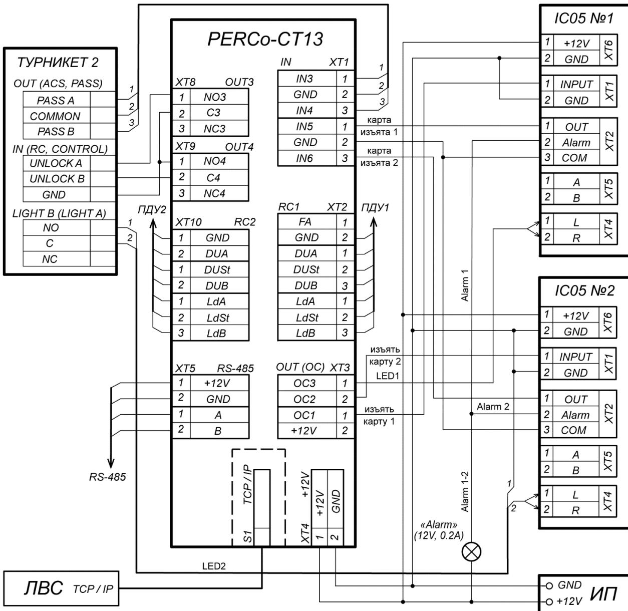
Рисунок 33. Схема подключения к ЭП турнекета и двух картоприемников PERCo-IC05
