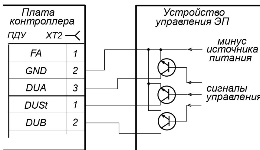
**Рисунок 10. Управляющие элементы устройства управления ЭП:
