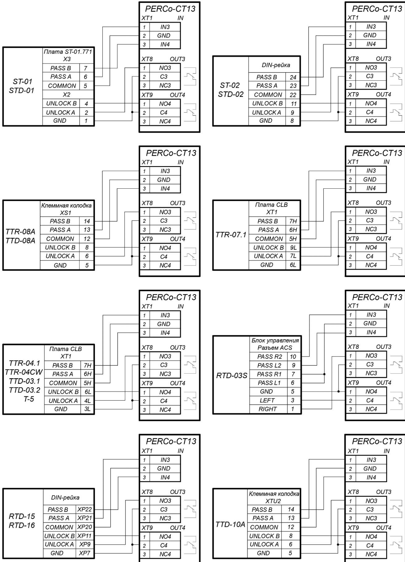
Рисунок 18. Схемы подключений турникетов
