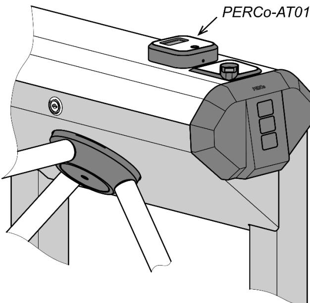
**Рисунок 39. Место установки пирометра PERCo-AT01 на крышку ЭП**
