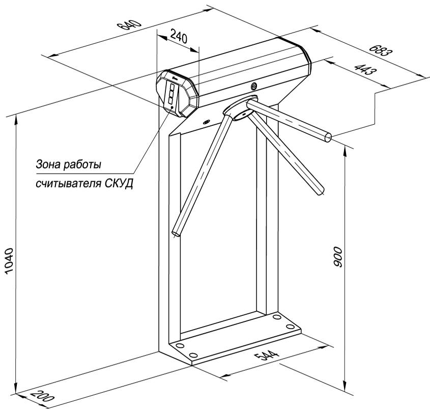
**Рисунок 5 – Габаритные размеры ЭП**
