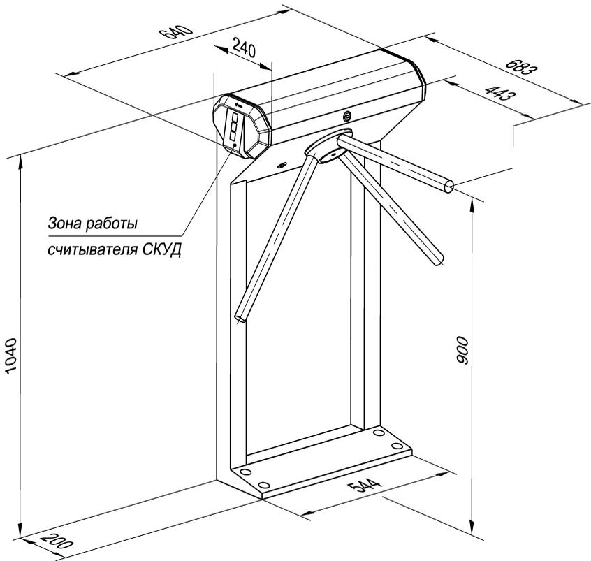
Рисунок 5 – Габаритные размеры ЭП
