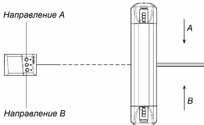
**Рисунок 6. Стандартная ориентация ПДУ относительно стойки ЭП**
