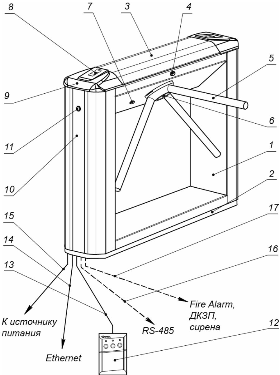
**Рисунок 2. Устройство ЭП**
