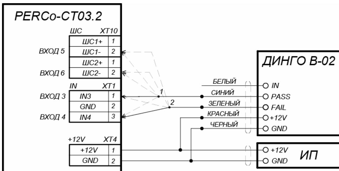
Рисунок 17. Схема подключения алкотестера «Динго В-02» (ООО СИМС-2)
