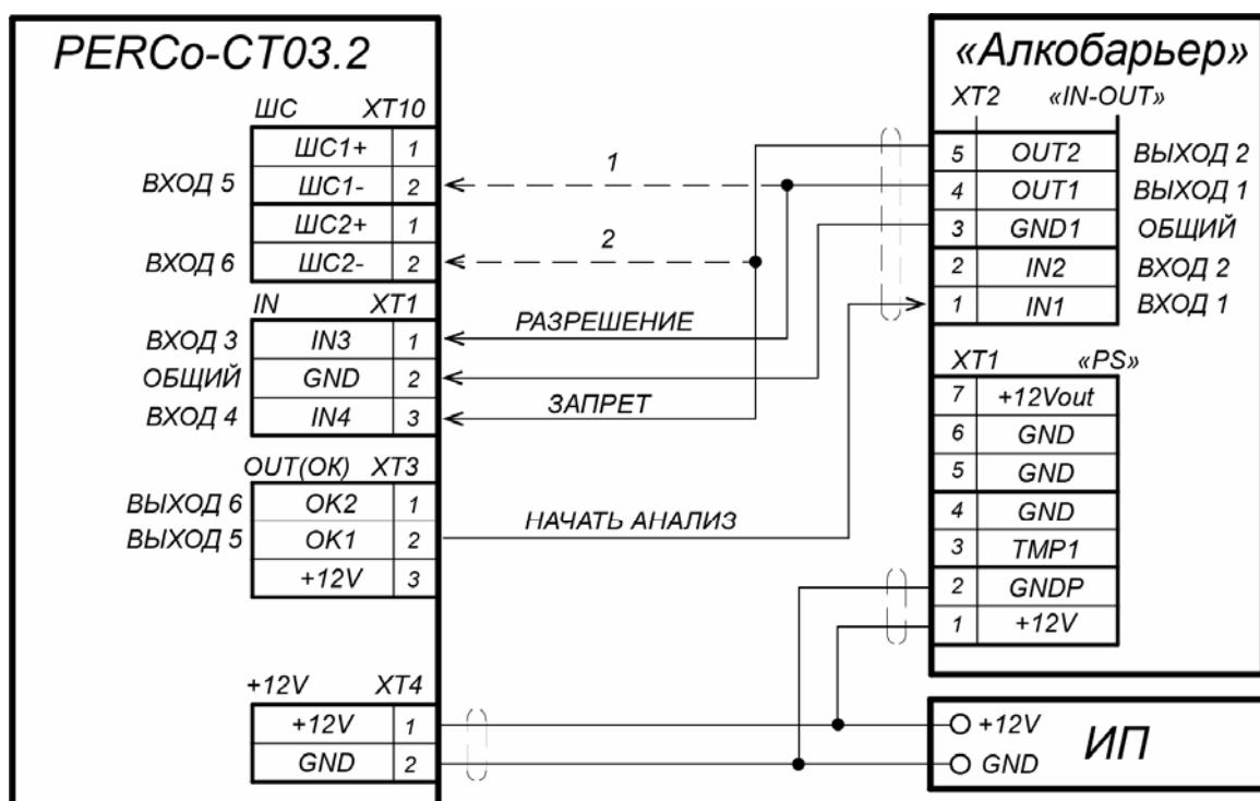
Рисунок 16. Схема подключения алкотестера «Алкобарьер» (ООО «Алкотектор»)
