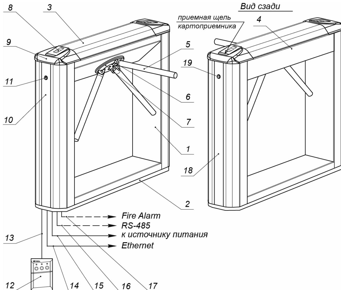
**Рисунок 1. Устройство ЭП**
