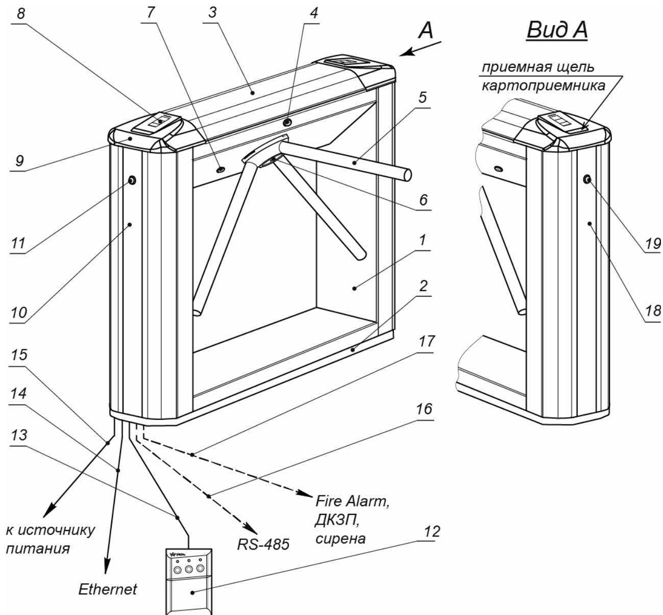
**Рисунок 1. Устройство ЭП**
