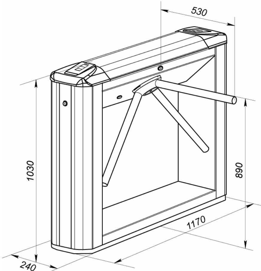
Рисунок 1. Габаритные размеры ЭП
