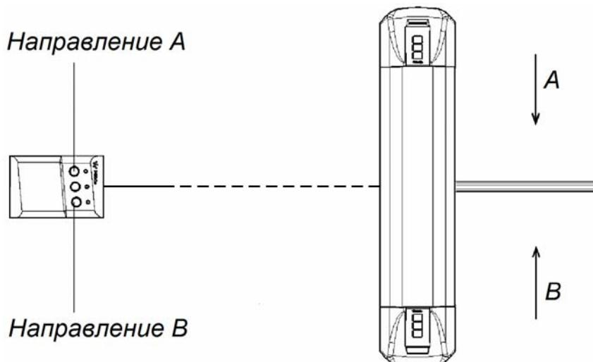
**Рисунок 7. Стандартная ориентация ПДУ относительно стойки ЭП**
