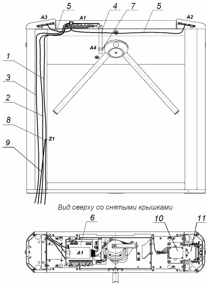
**Рисунок 12. Схема прокладки кабелей в стойке ЭП**
