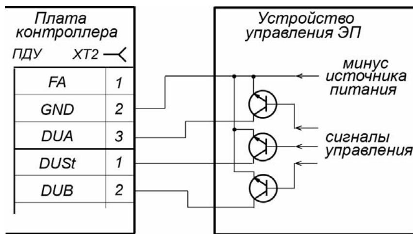
**Рисунок 9. Управляющие элементы устройства управления ЭП:
