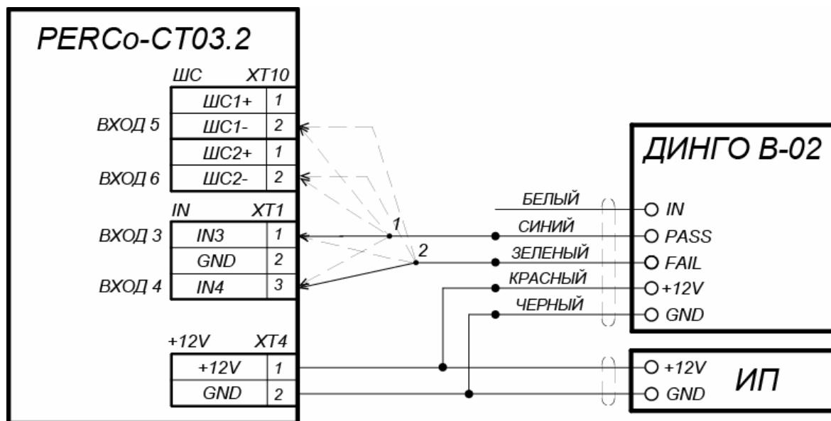
1, 2 - для подключения ДИНГО В-02 используется два разных входа контроллера из любых свободных.
