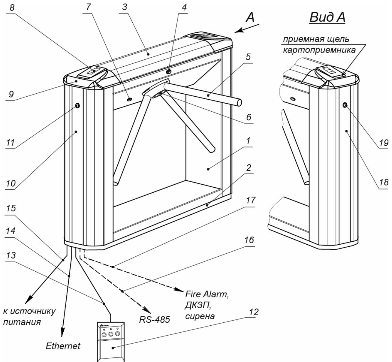
**Рисунок 2. Устройство ЭП**
