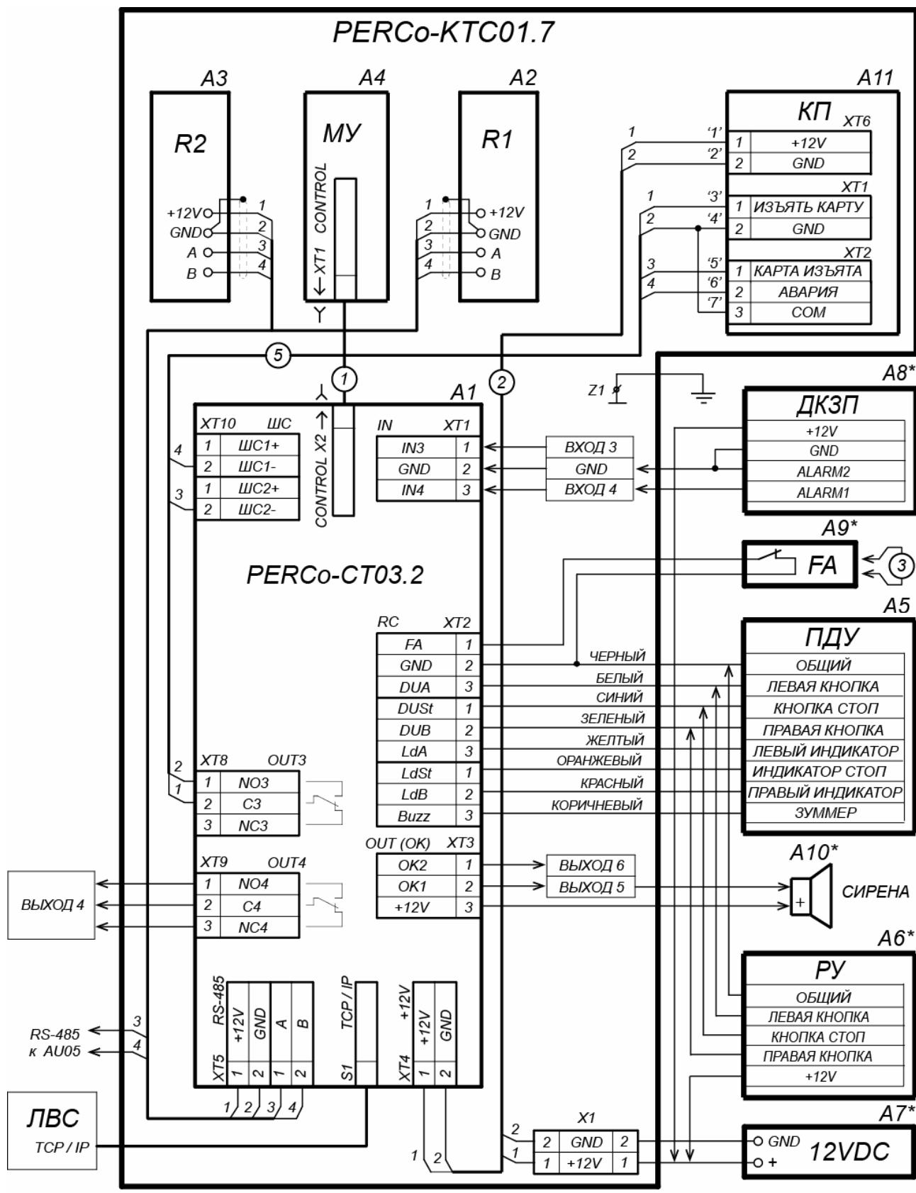
Рисунок 13. Схема подключения ЭП и дополнительного оборудования
