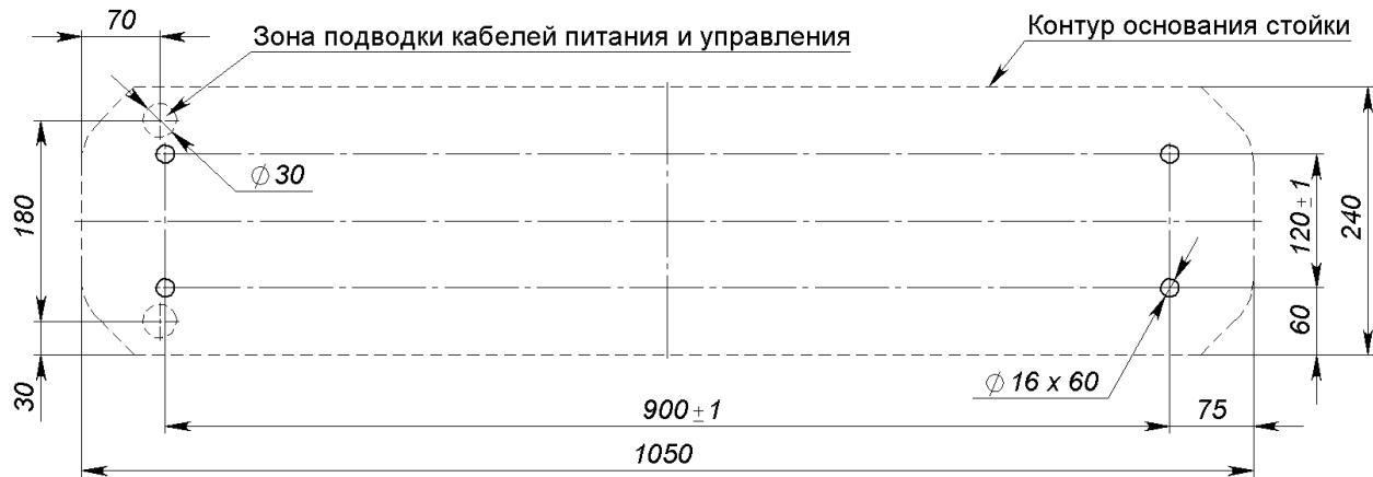
**Рисунок 6 — Схема разметки для установки стойки КТС01**
