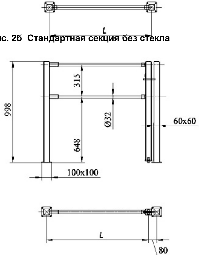
Рис. 2г Поворотная секция Антипанка с запирающим устройством
