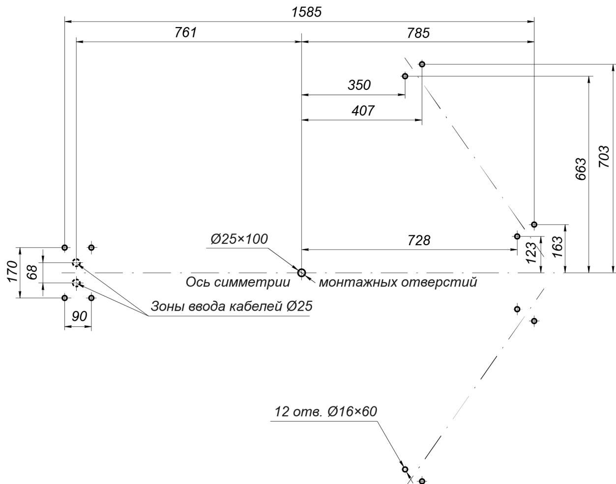
**Рисунок 11. Схема разметки для монтажа турникета<sup>1</sup>**
