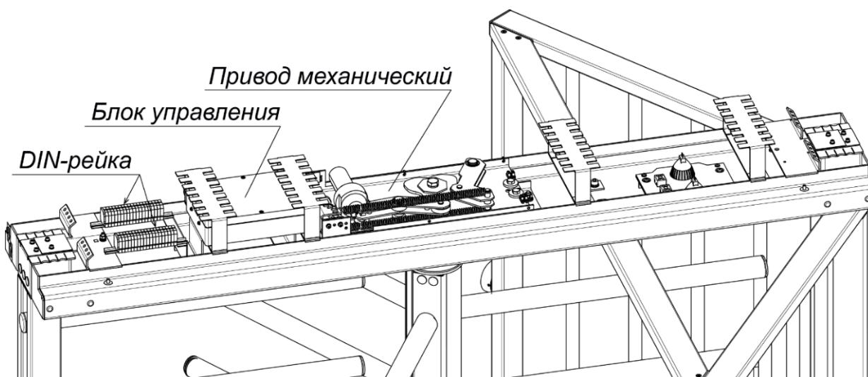
Рисунок 4. Вид балки привода турникета PERCo-RTD-16.2 без крышки
