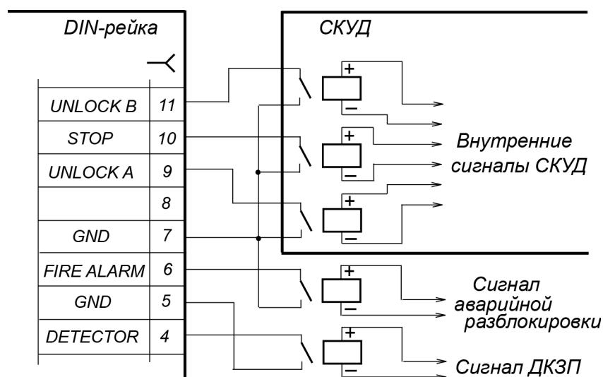
Рисунок 7. Управляющие элементы: нормально разомкнутые контакты реле
