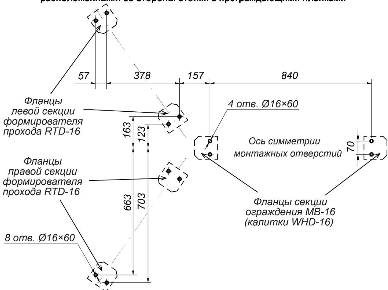
**Рисунок 28. Схема разметки для монтажа турникета с ограждением или калиткой, расположеннымными со стороны секций формирования прохода<sup>2</sup>**
