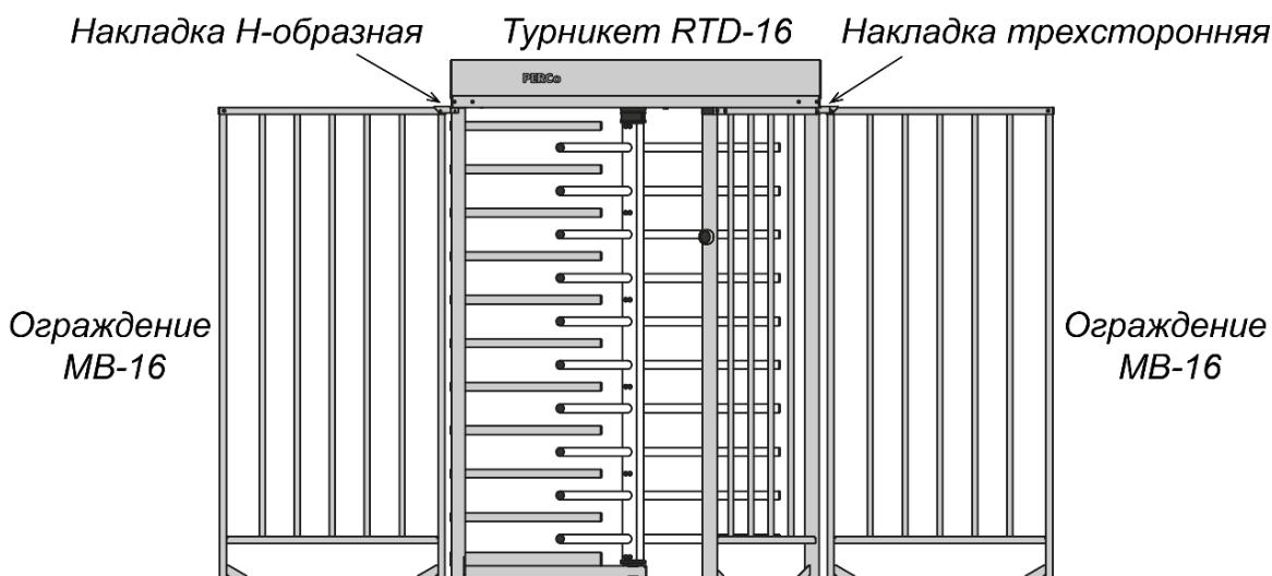
Рисунок 26. Пример взаимного расположения турникета с ограждением
