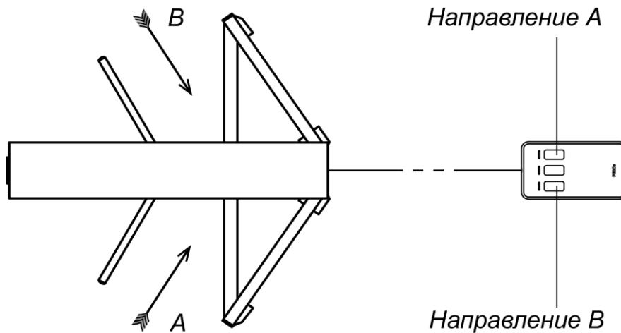
**Рисунок 6. Стандартная ориентация ПДУ относительно стойки турникета**
