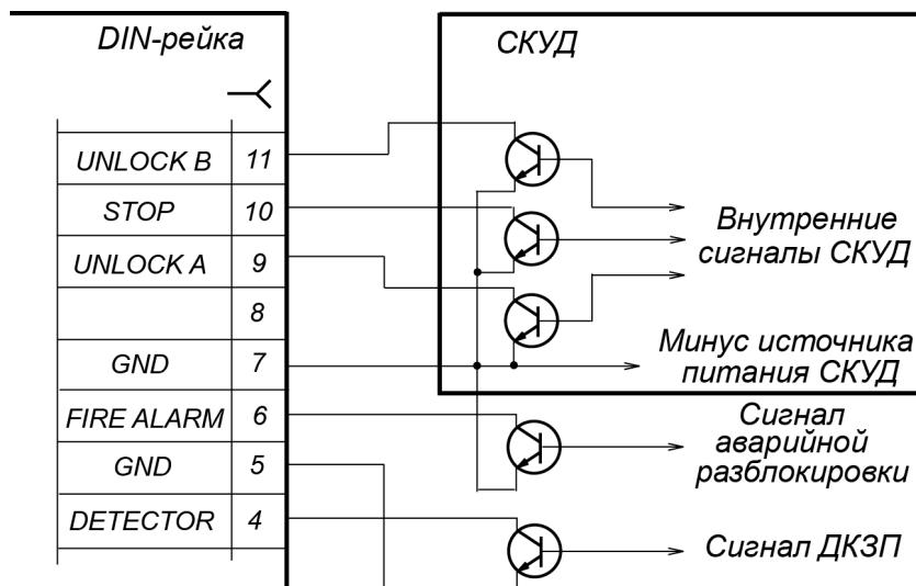
Рисунок 8. Управляющие элементы: схема с открытыми коллекторными выходами
