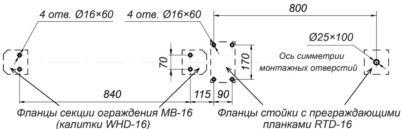
**Рисунок 27. Схема разметки для монтажа турникета с ограждением или калиткой, расположеннымными со стороны стойки с преграждающими планками<sup>1</sup>**
