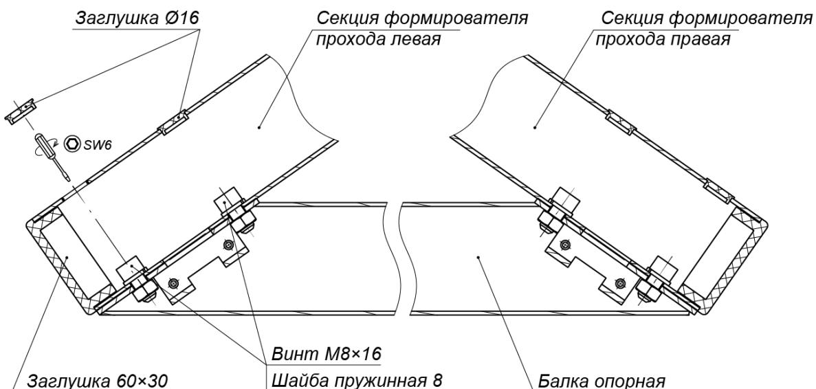
**Рисунок 12. Крепление балки опорной (7) к секциям (6) формирователя прохода**
