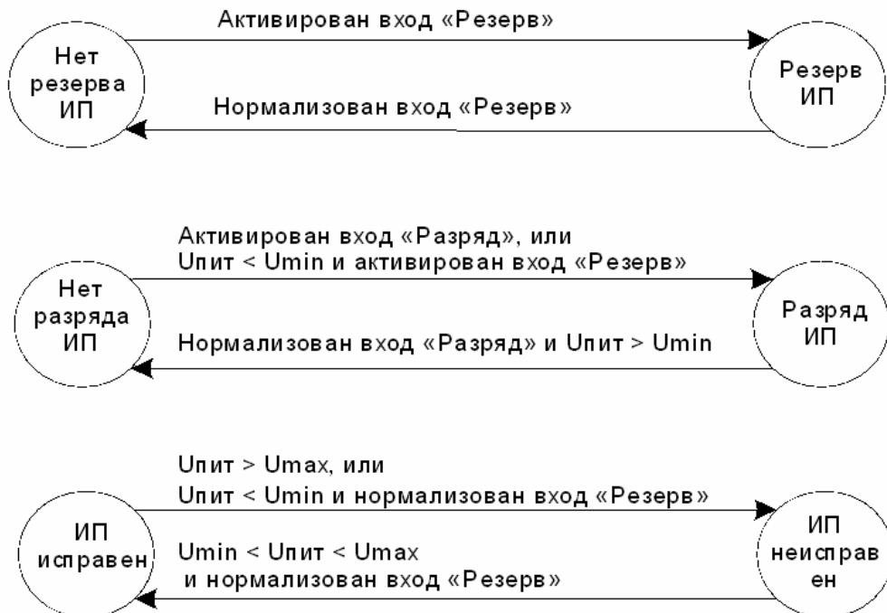
Рисунок 10: Мониторинг состояния ИП.
