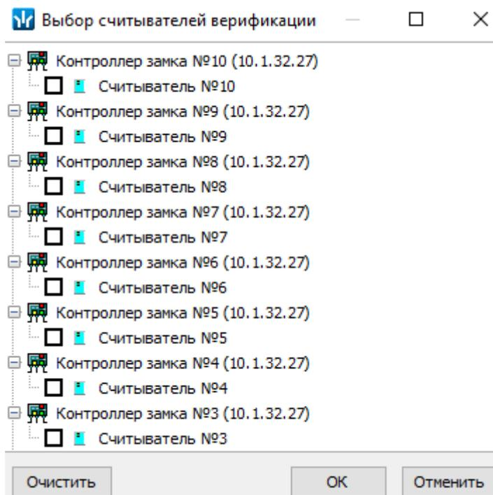
Отметьте флажками считыватели события, связанные с которыми должны отображаться в рабочей области раздела.
