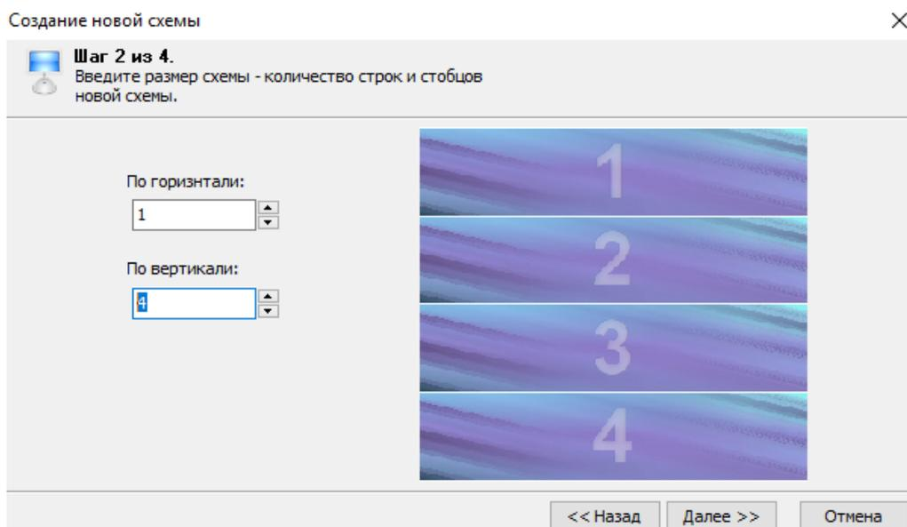
4. В открывшемся окне укажите с помощью счетчика **По горизонтали:** необходимое количество столбцов, а с помощью счетчика **По вертикали:** необходимое количество рядов видеоокон для вывода изображений с необходимого количества камер. При этом в правой части окна будет отображаться установленный вариант расположения в рабочей области раздела. Нажмите кнопку **Далее**. Откроется окно для выбора камер:
