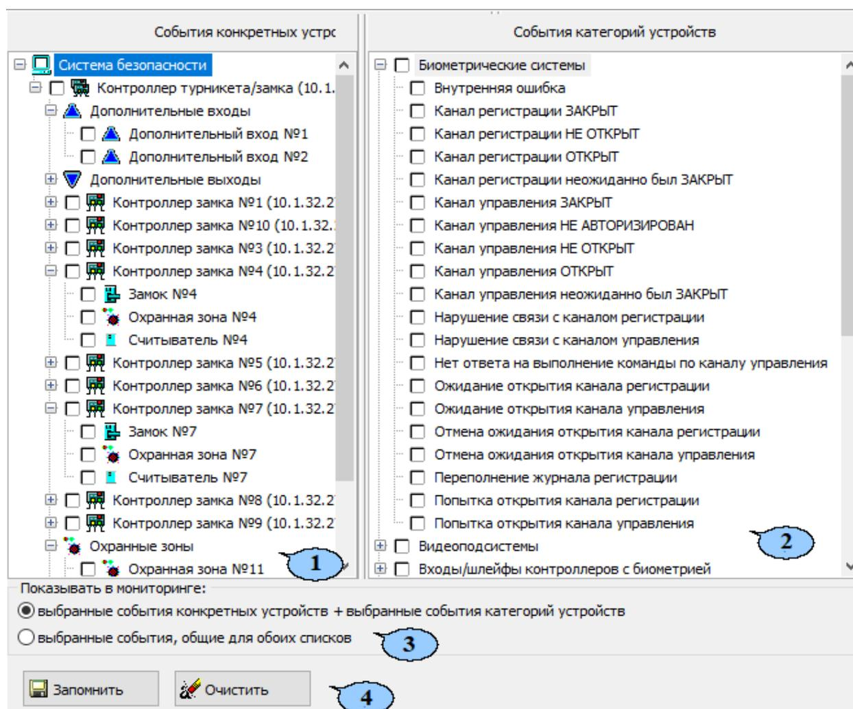
1. Панель **События конкретных устройств** содержит многоуровневый выпадающий список устройств и их ресурсов, добавленных в конфигурацию системы безопасности.
