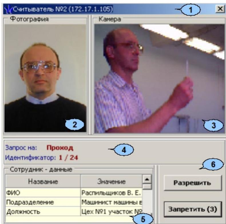
1. В строке заголовка окна отображается описательное название считывателя, с которым связана точка верификации и IP-адрес контроллера к которому он подключен.
