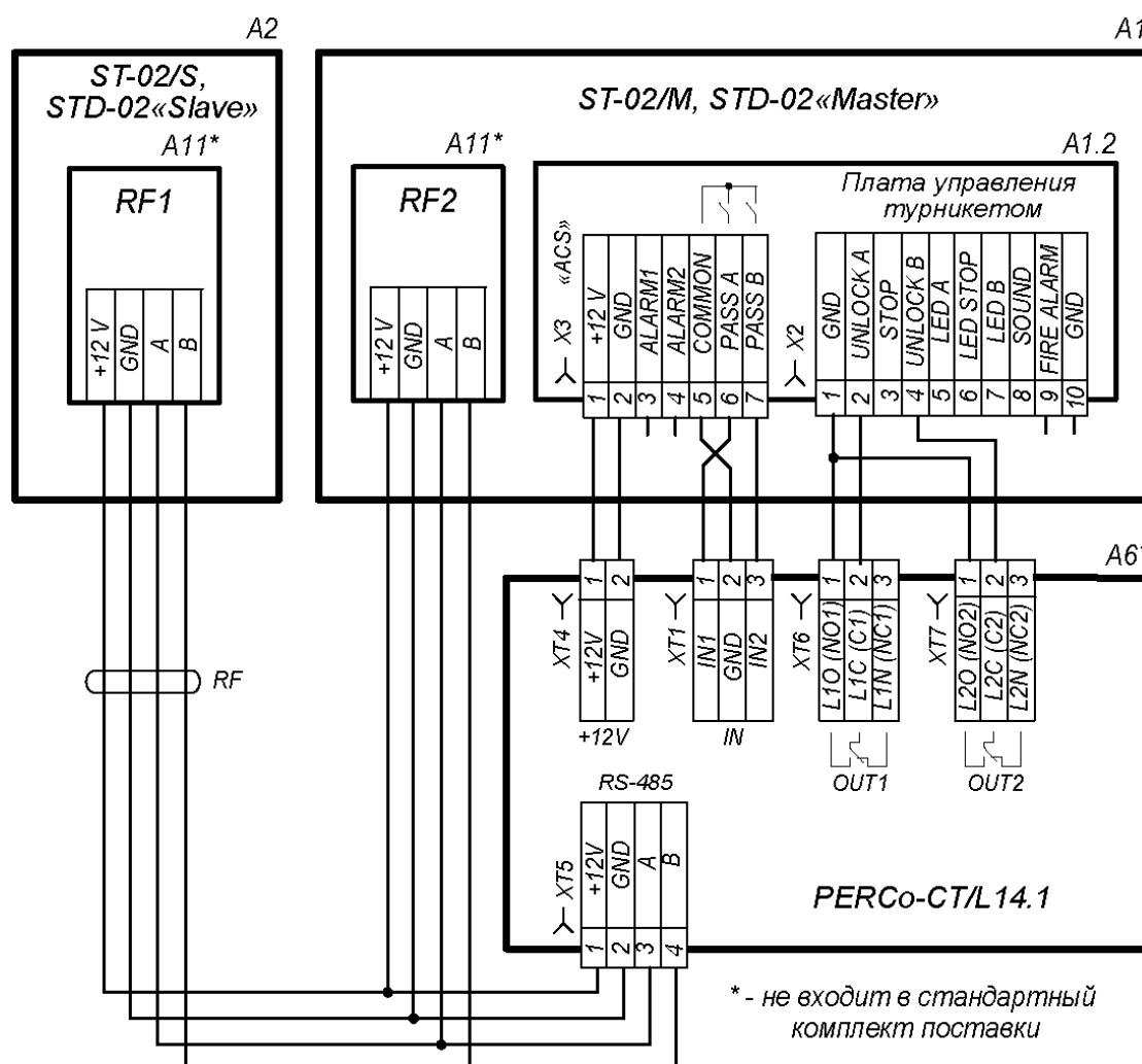
Рисунок 18. Вариант подключения к турникету контроллера СКУД PERCo-CT/L14.1
