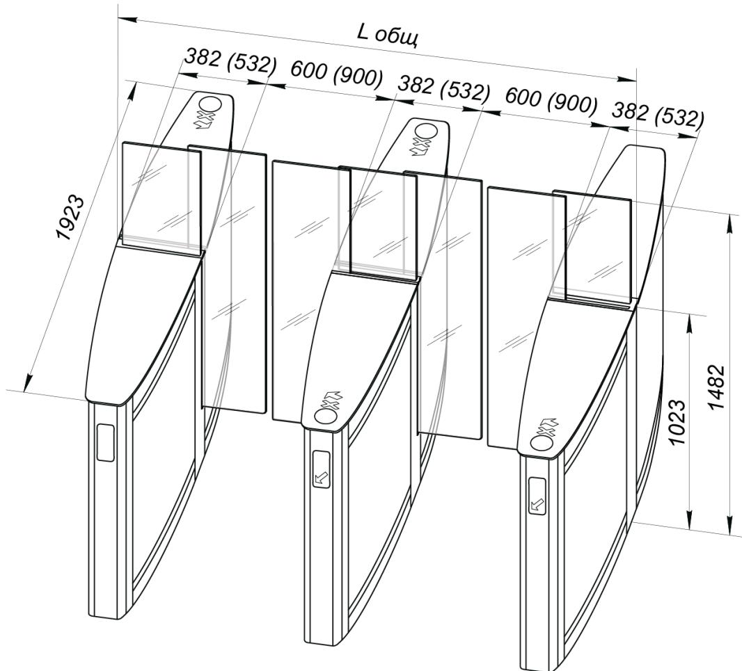
Рисунок 2. Габаритные размеры при организации нескольких зон прохода
