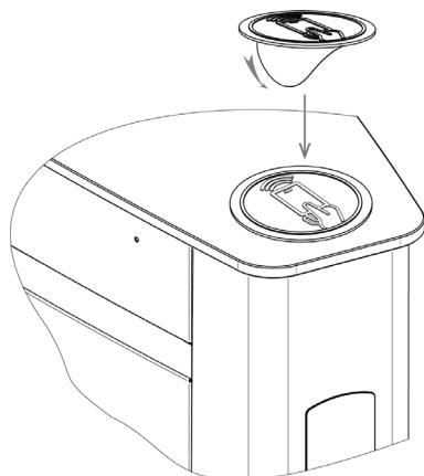
Рисунок 27. Наклеивание резиновой накладки на стеклянную крышку
