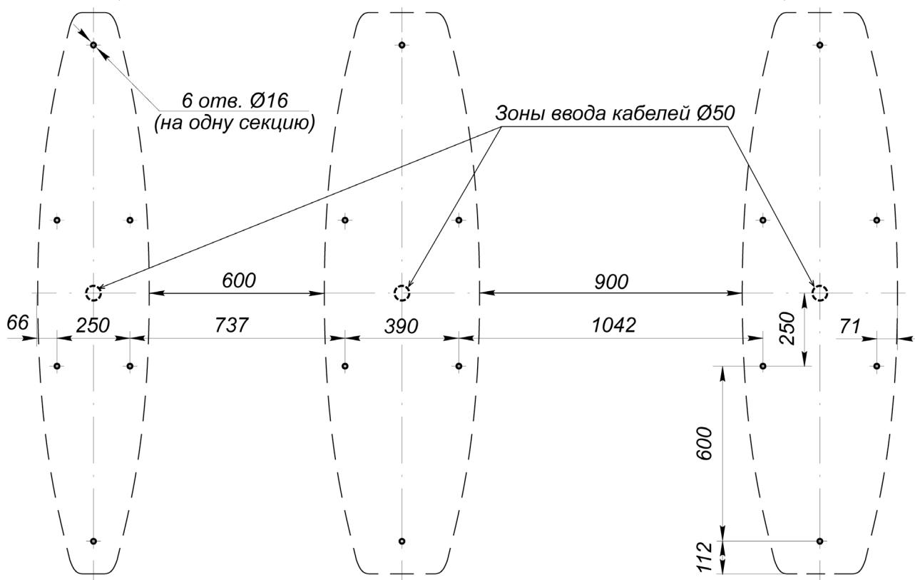
**Рисунок 15. Схема разметки для совместного монтажа секций турникета с разной шириной зон прохода**
