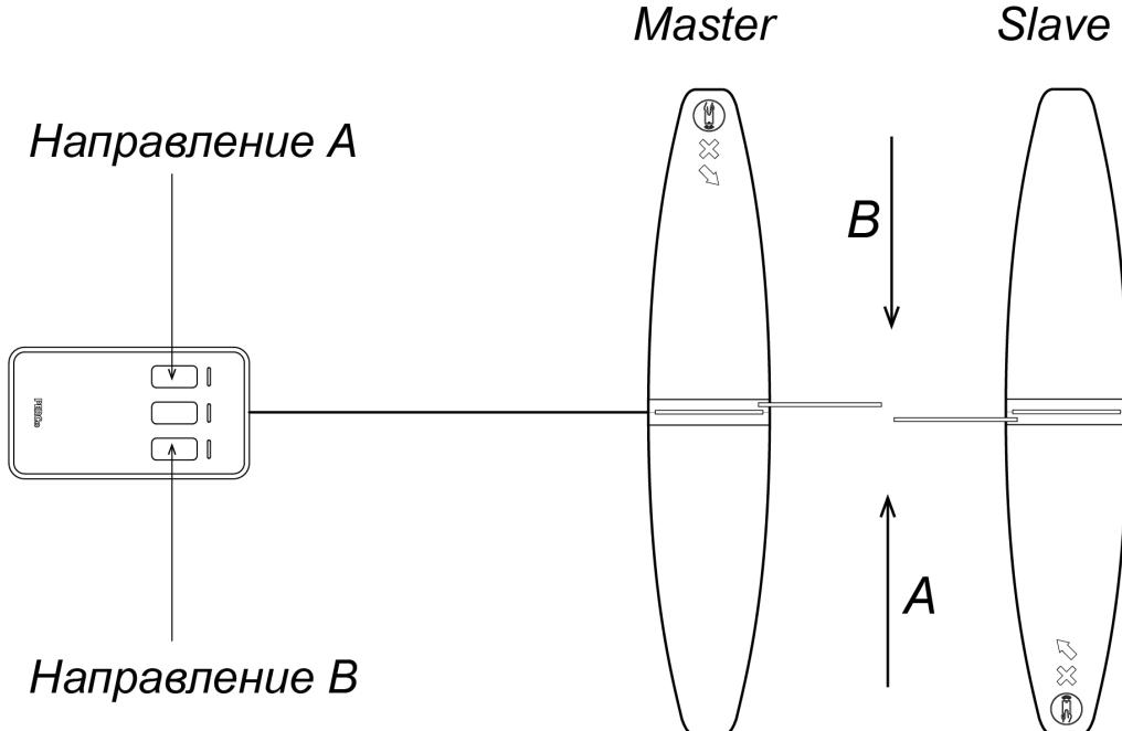
Рисунок 10. Стандартная ориентация ПДУ относительно секций турнкета
