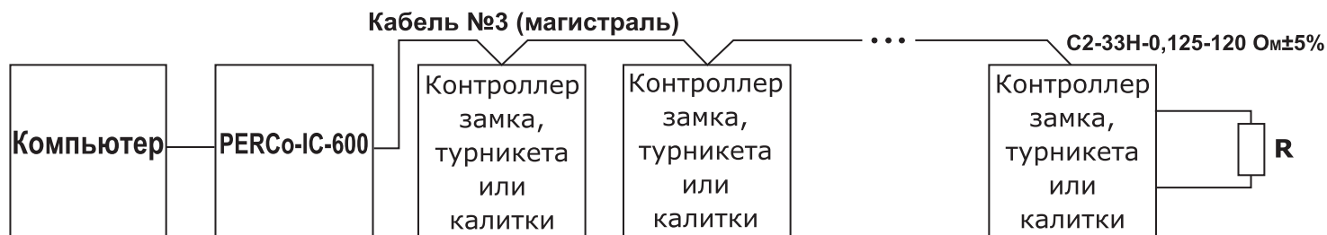
Рисунок 1 - Схема соединения контроллеров в системе
