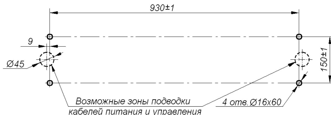
Рисунок 11. Схема разметки отверстий для крепления стойки турникета<sup>1</sup>
