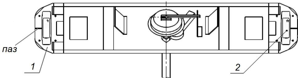
*Крышка турникета (вид снизу)*
