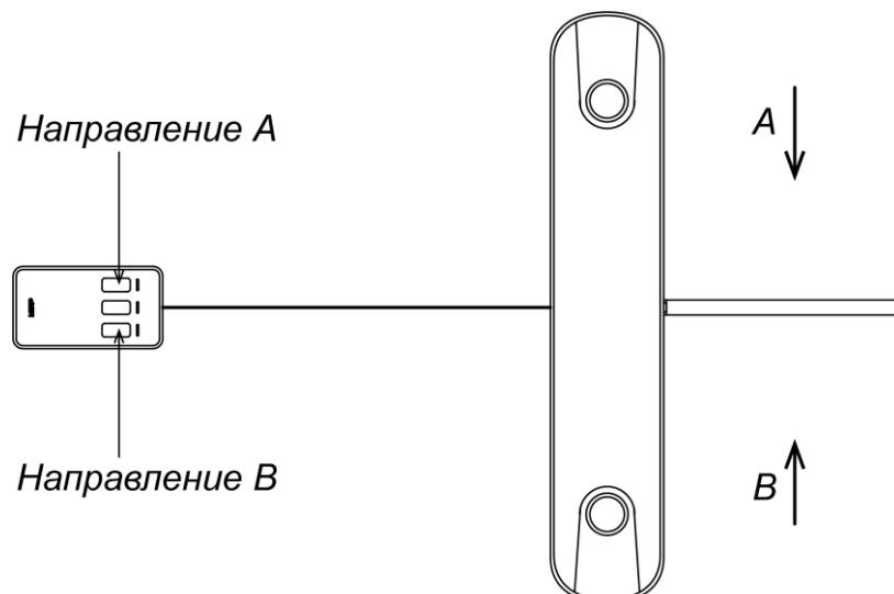
**Рисунок 7. Стандартная ориентация ПДУ относительно стойки турникета**
