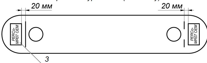
**Рисунок 13. Место установки считывателя СКУД**
