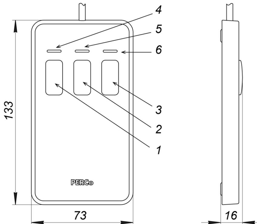
**Рисунок 4. Общий вид и габаритные размеры ПДУ**
