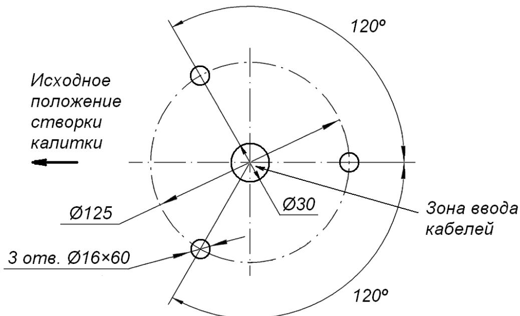
**Рисунок 8. Схема разметки для монтажа калитки<sup>2</sup>**
