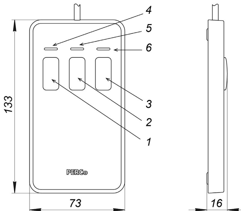
**Рисунок 3. Общий вид и габаритные размеры ПДУ**
