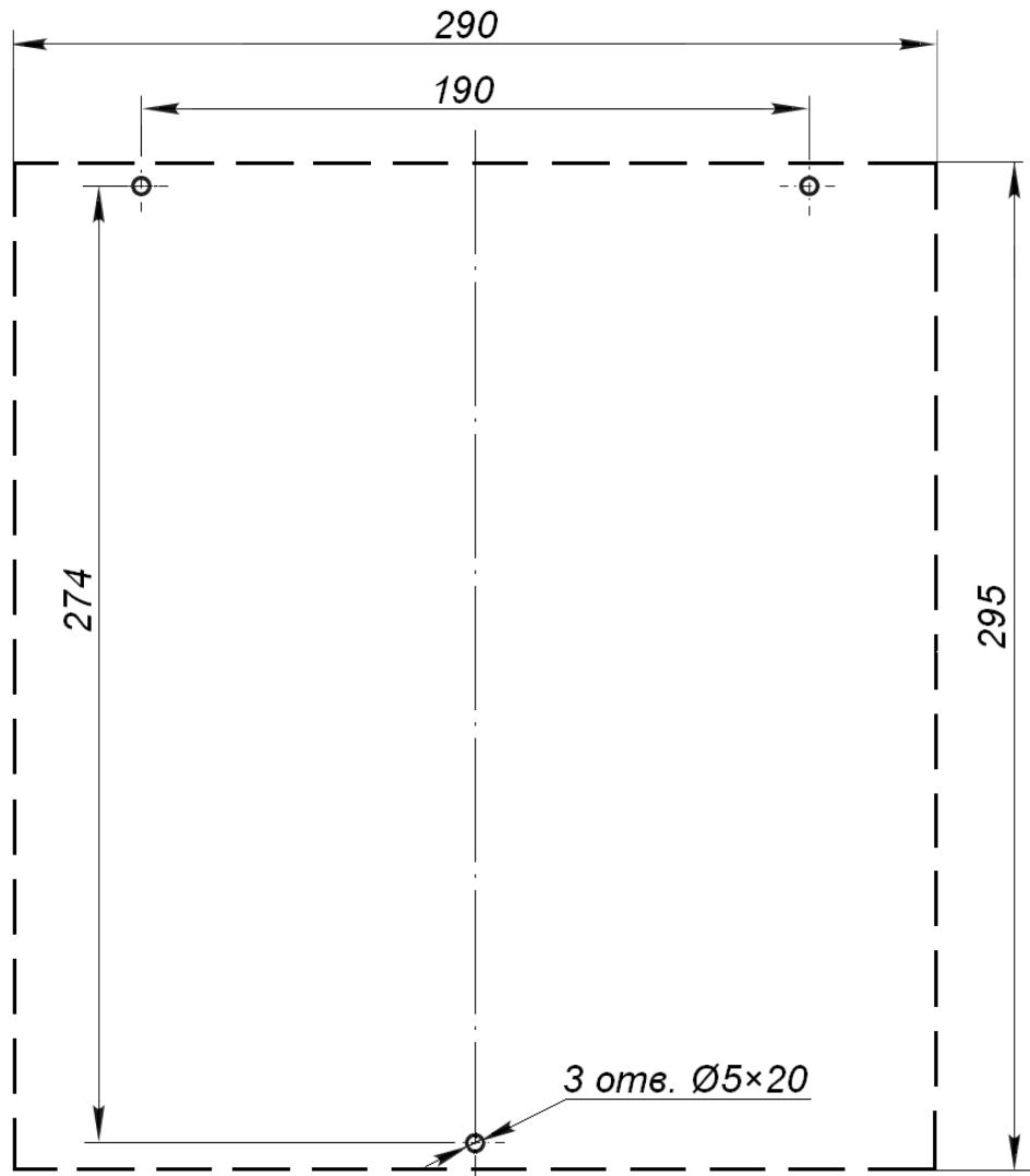
**Рисунок 9. Разметка отверстий для крепления БУ на стене**
