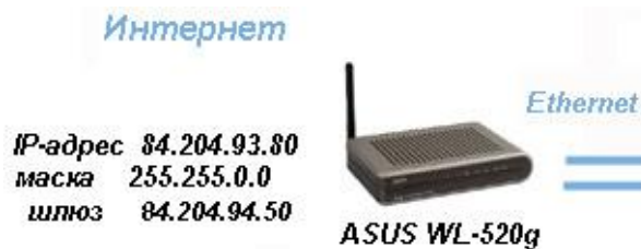
Рис.2 IP-адреса маршрутизаторов в сети Интернет
