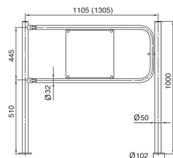
Механическая поворотная секция ограждения
