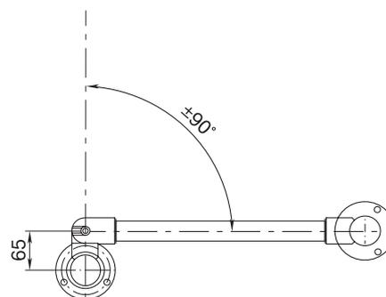
Схема возможных углов поворота поворотного патрубка PERCo-ВН02 0-01
