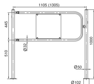
Автоматическая поворотная секция ограждения
