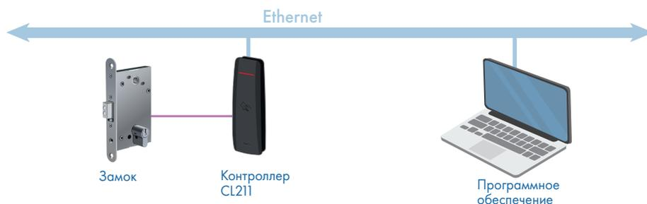
Замок управляется в потенциальном режиме. Для нормально закрытых замков разблокировка производится подачей управляющего напряжения, для нормально открытых замков – снятием управляющего напряжения.
